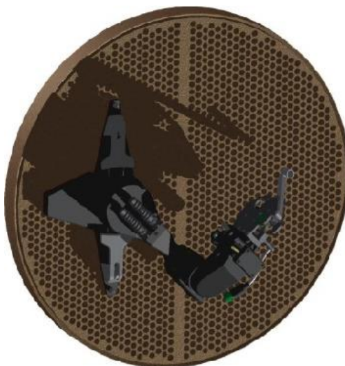
Slika 17. Načini prihvata sustava Spyder na cijevnu stjenku
