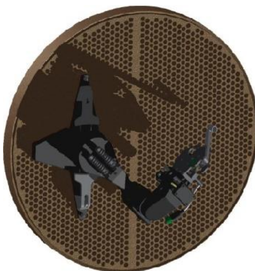
Slika 17. Načini prihвата sustava Spyder na cijevnu stjenku
