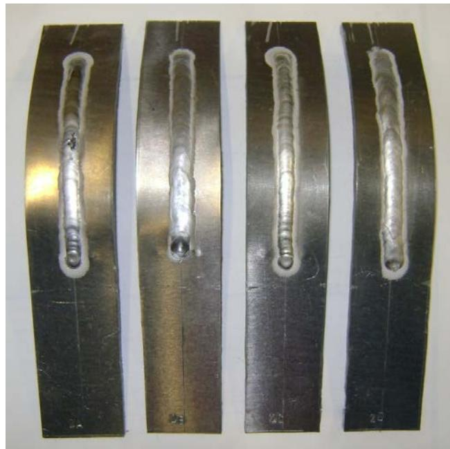
**Slika 7.17. Uzorci 2 nakon provedenog čišćenja**
