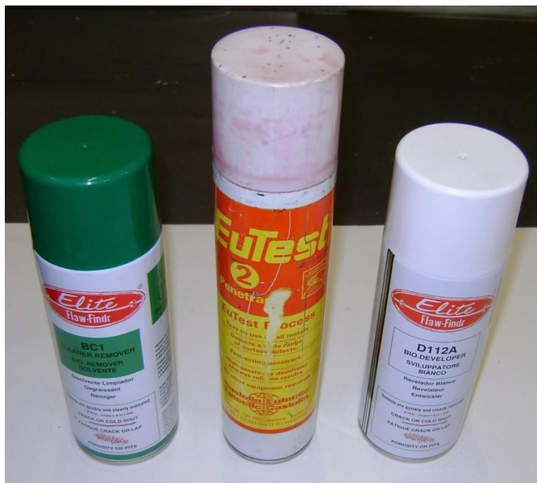
Slika 7.15. Čistač, penetrant i razvijač koji su korišteni u postupku
