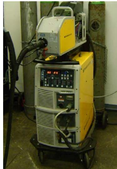
**Slika 7.9. Izvor struje za zavarivanje Welbee P400**
