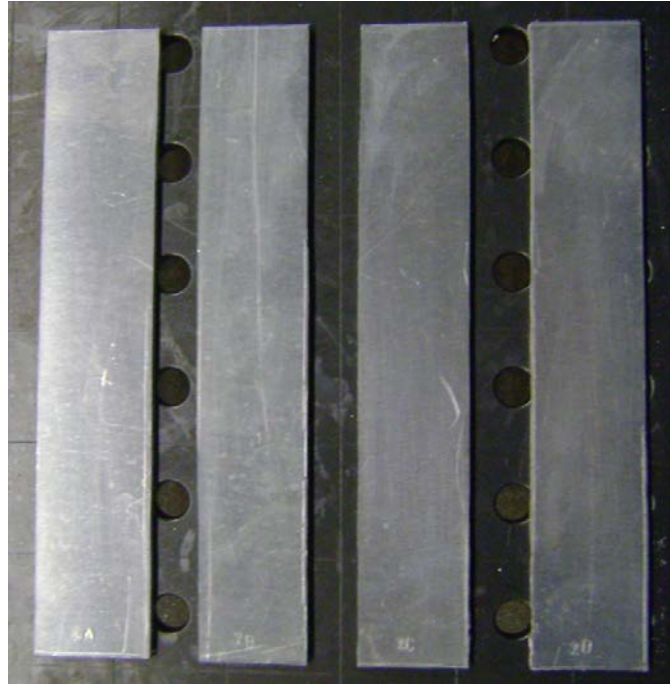
Slika 7.7. Izrezani i označeni uzorci iz lima 2
