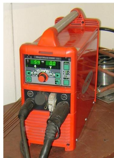
**Slika 7.10. Izvor struje za zavarivanje MagicWave 2200 Job**
