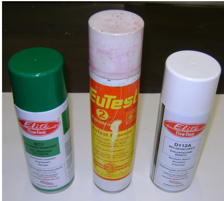
Slika 7.15. Čistač, penetrant i razvijач koji su korišteni u postupku
