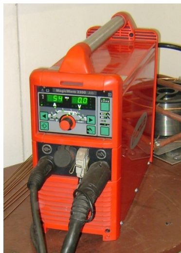
Slika 7.10. Izvor struje za zavarivanje MagicWave 2200 Job
