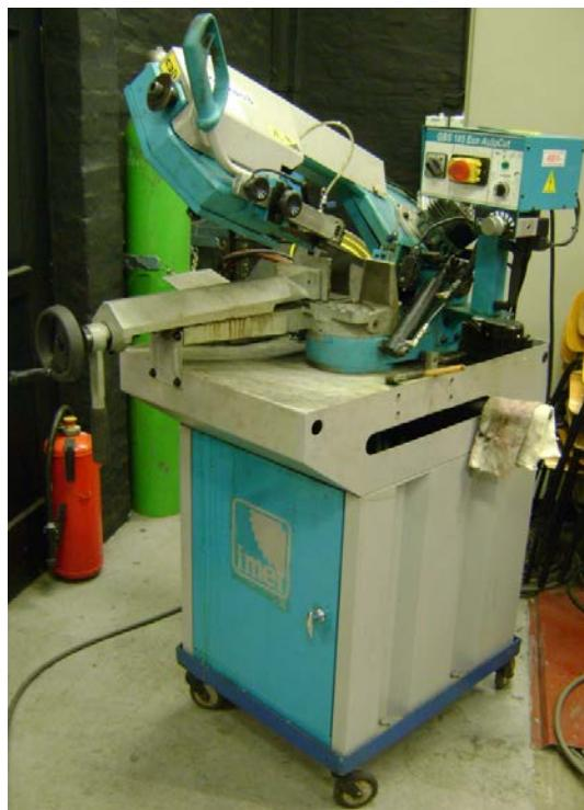
Slika 7.24. Tračna pila GBS 185 Eco AutoCut
