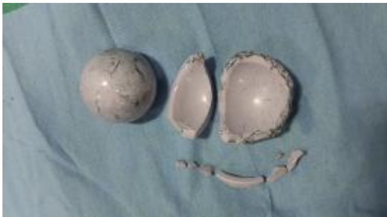
Slika 4. Slomljena čašica umjetnog kuka [6]
