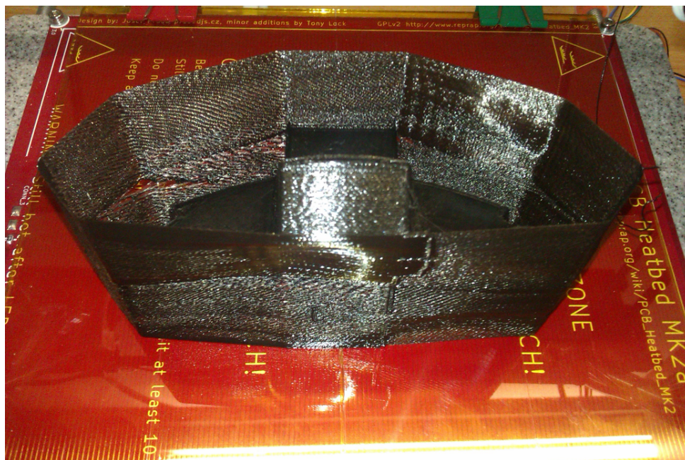
Slika 25: Printanje centralnog dijela kacige
