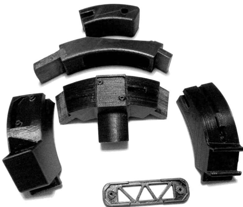
Slika 26: Isprintani dijelovi kacige
