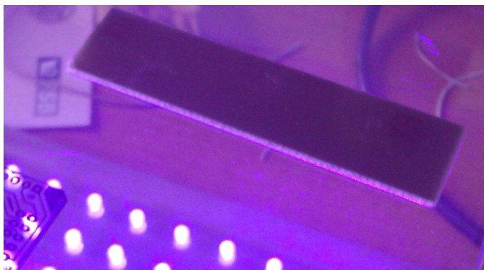
Slika 14: Osvjetljavanje fotopozitivne pločice
