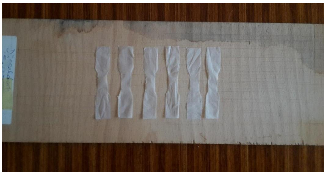
**Slika 25.** Izrezane epruvete za ispitivanje vlačne žilavosti
