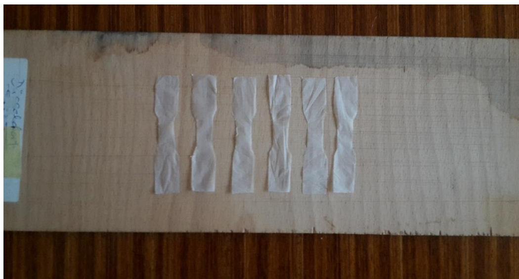
Slika 25. Izrezane epruvete za ispitivanje vlačne žilavosti
