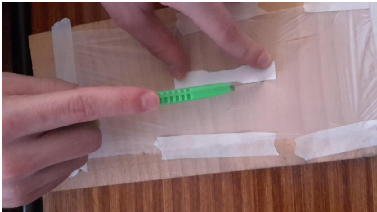
Slika 8. Izrada epruveta za ispitivanje vlačne žilavosti
