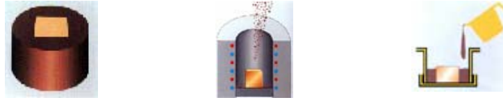
Slika 12. Zalijevanje uzoraka: a) uzorak u masi, b) ulijevanje na toplo i c) ulijevanje na hladno [6].
