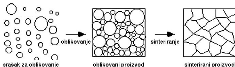
Slika 6. Zgušnjavanje mase oblikovanjem za daljnu obradu (sinteriranje).
