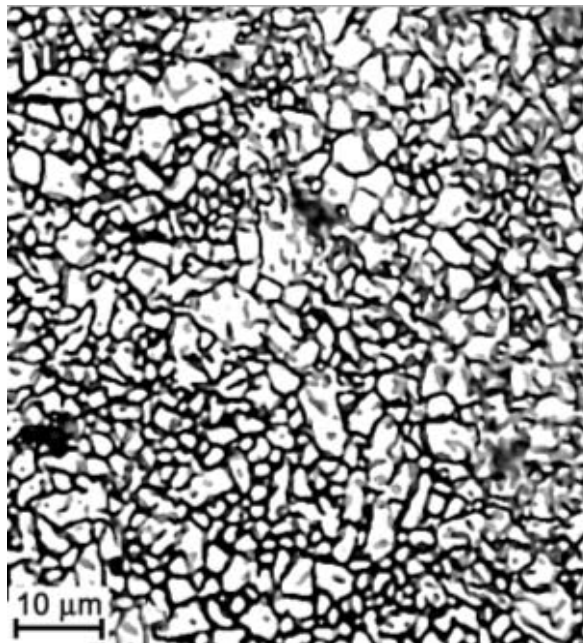
Slika 3. Mikrostruktura sitnozrnate aluminij oksidne keramike [2].
