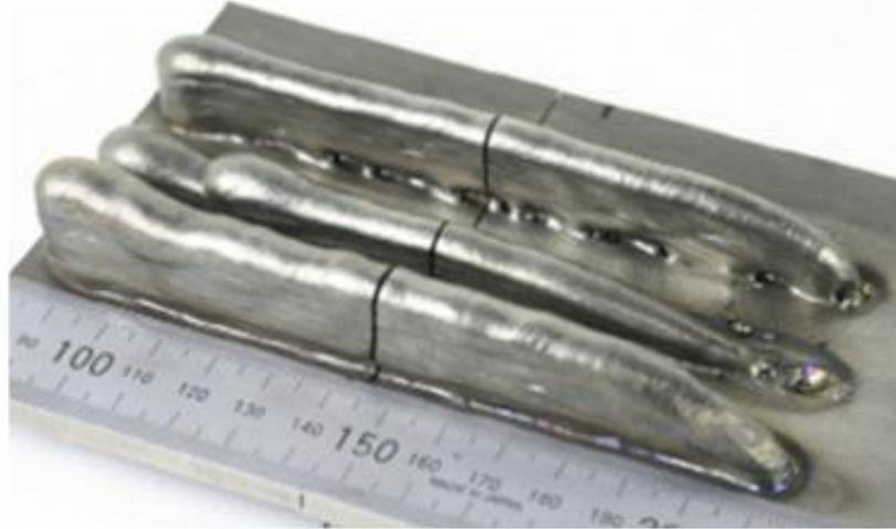
Slika 28: Razlika u geometriji zavara na početku i na kraju prolaza [3]
