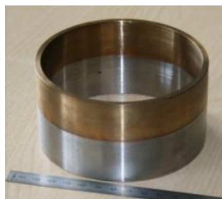
Slika 20: Prsten dobiven kombinacijom čelika i bakra [13]
