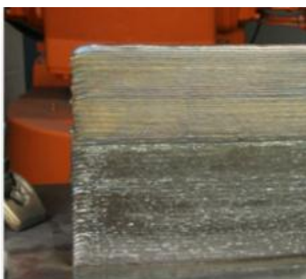
Slika 19: Kombinacija čelika i invara [13]
