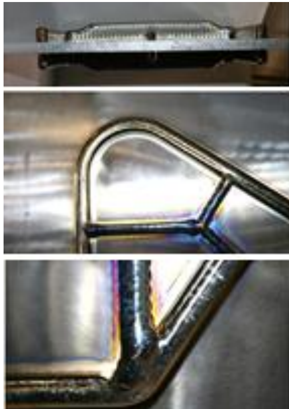
Slika 38: Okvir izrađen WAAM sustavom [21]
