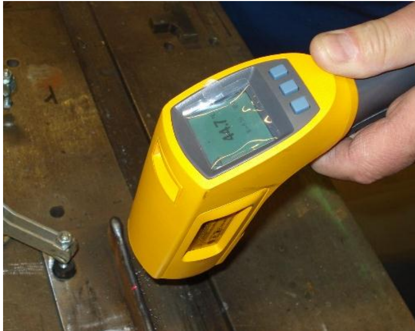
Slika 43: Mjerenje temperature međuprolaza
