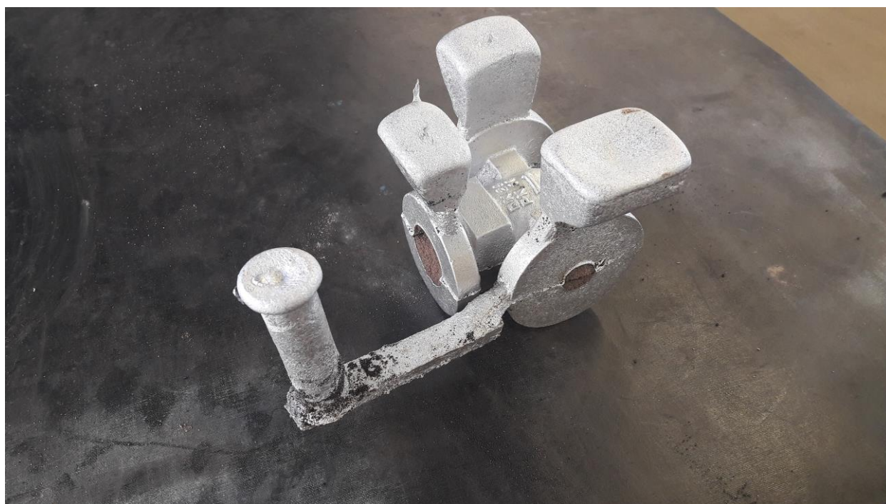
Slika 54. Konačni oblik drugog odljevka, varijanta II.
