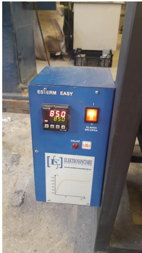
Slika 45. Display peći (zelena-zadana temperatura, crvena boja-postignuta temperatura)
