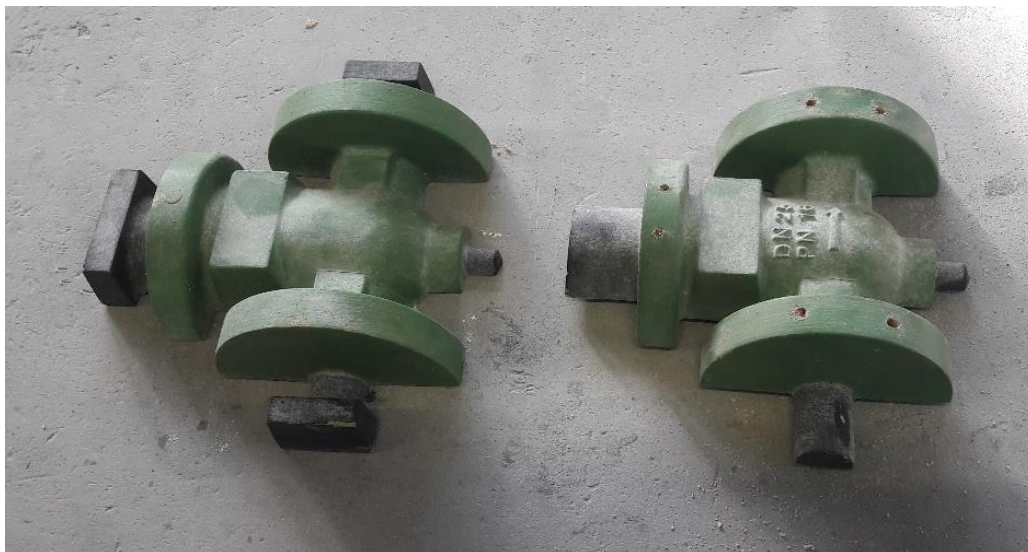
Slika 25. Dvodjelni model odljevka.
