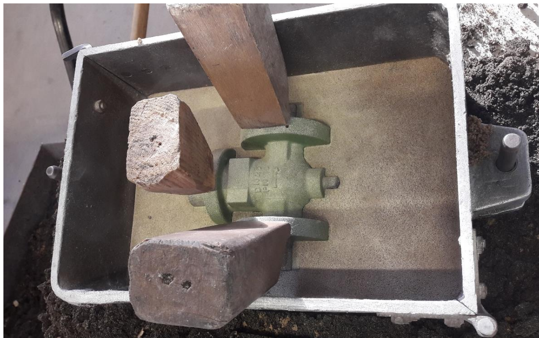
Slika 31. Poziciniranje modela pojila u gornjak.
