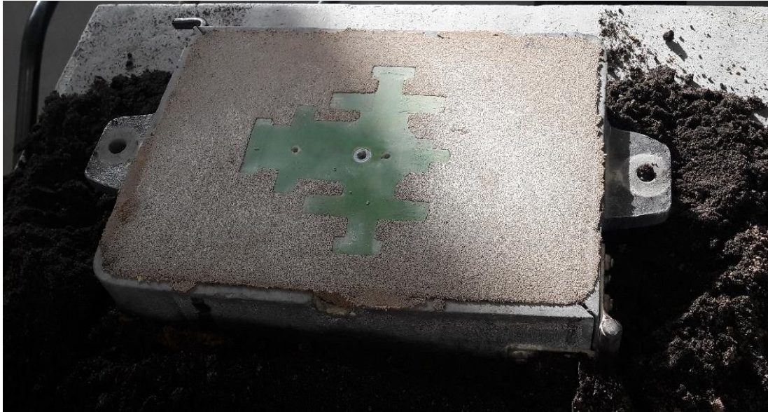
Slika 29. Izgled donjeg dijela kalupa s modelom.
