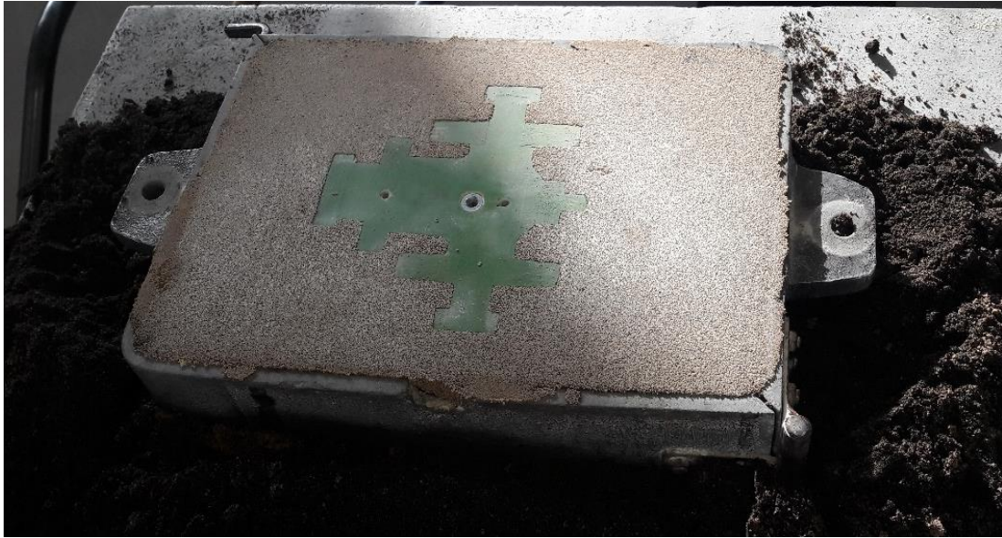
Slika 29. Izgled donjeg dijela kalupa s modelom.
