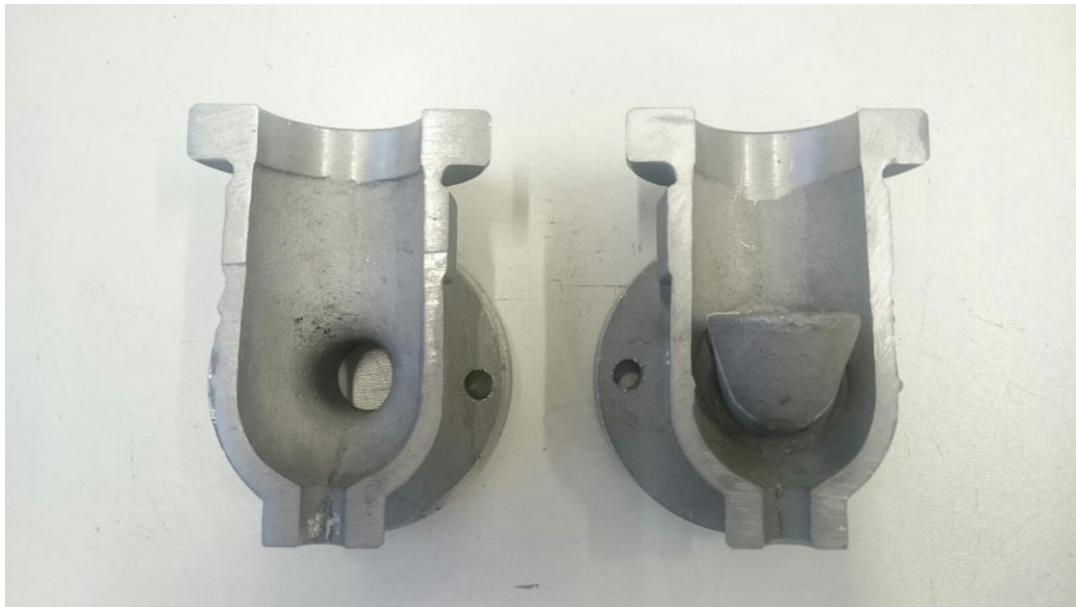
Slika 55. Poprečni presjek odljevka.
