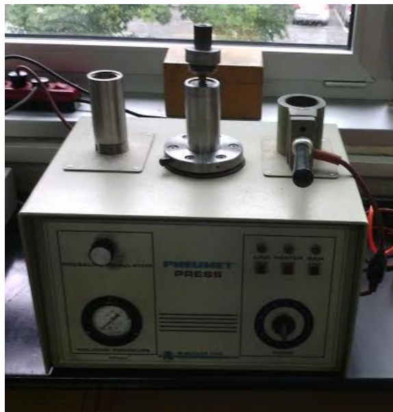
Slika 41. Uređaj za zalijeivanje uzoraka
