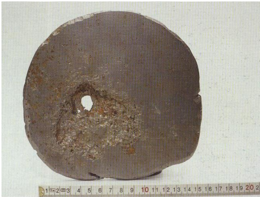
Slika 6. Korozija u procijepu – na otvorenom dijelu kotla kod nelegiranog čelika [9]
