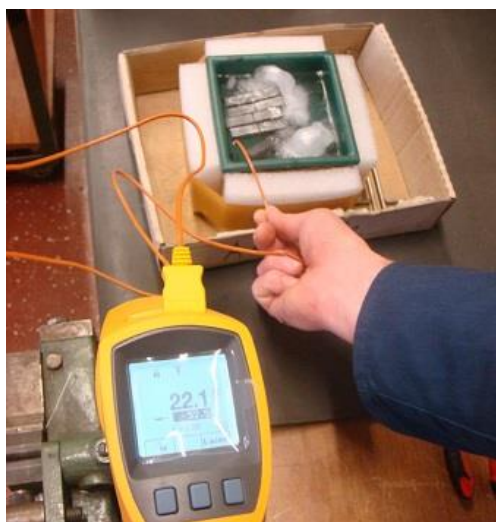
Slika 46. Ohlađivanje uzoraka na -40^{\circ}
