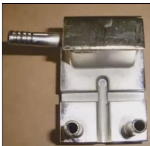
Slika 11. Vodom hlađena pokretna papuča [2]
