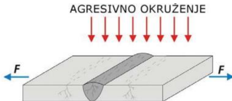
Slika 11. Čimbenici koji utječu na pojavu napetosne korozije
