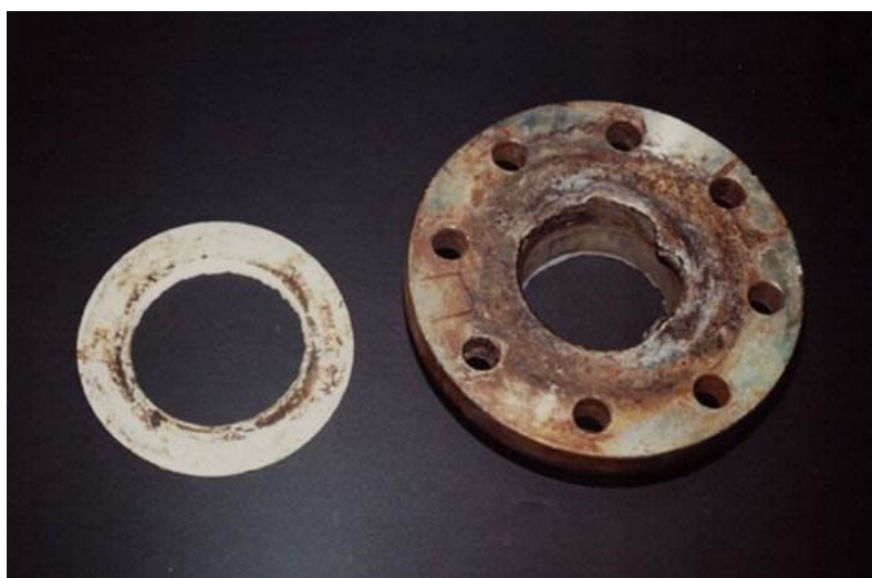
Slika 7. Prikaz korozijskog oštećenja uslijed korozije u procjepu
