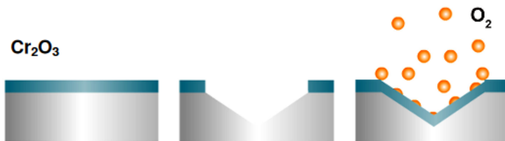
Slika 6. Mehanizam samoobnavljanja pasivnog filma kromovih oksida na površini [19]
