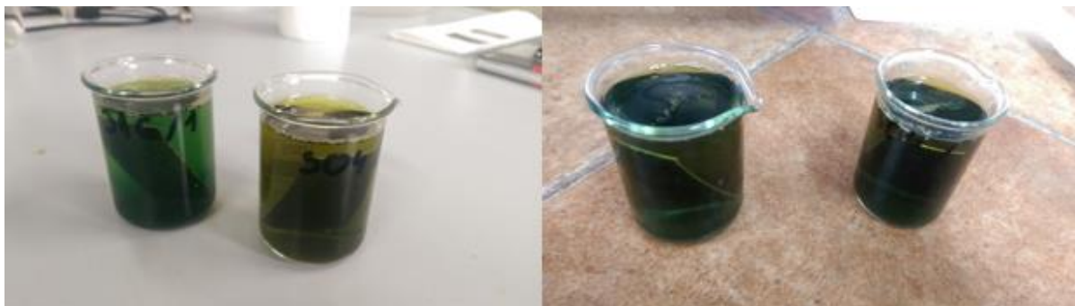
Slika 46. Prikaz uzoraka nakon izlaganja agresivnoj otopini nakon 24 sata pri sobnoj temperaturi (lijevo) i pri temperaturi 50 °C (desno)
