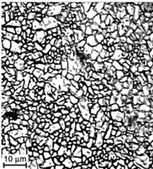
Slika 3. Mikrostruktura sitnozrnate aluminij oksidne keramike [2]
