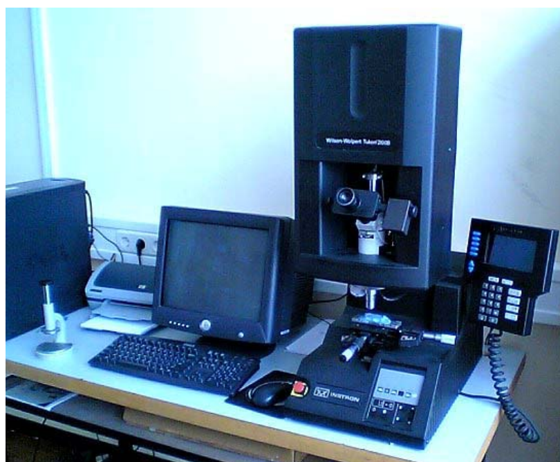
Slika 19. Mikrotvrdomjer Instron, Wilskon-Wolpert Tukon 2100B
