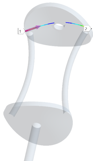
Slika 19. Pomaci u gornjoj ploči modela sa dva kraka
