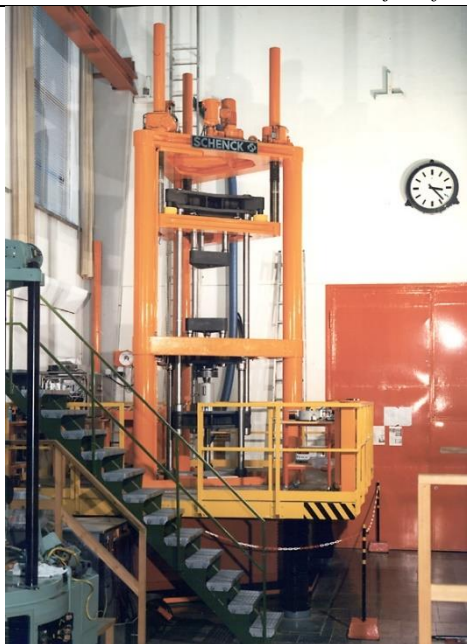
Slika 4. Primarni etalon sile 1 MN, PTB, Njemačka [6]
