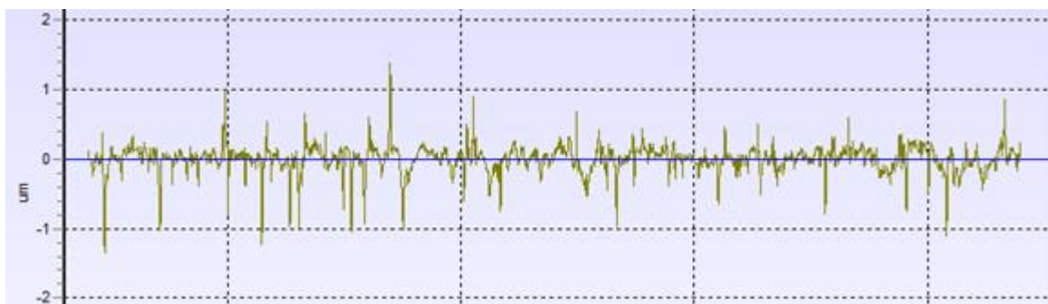
Slika 36. Profil hrapavosti prevlake za uzorak 1
