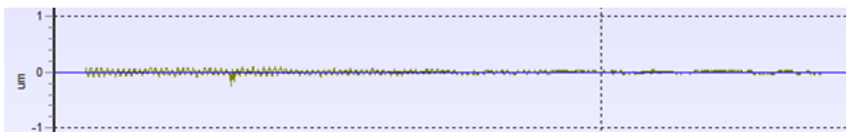
Slika 42. Profil hrapavosti prevlake za uzorak 3
