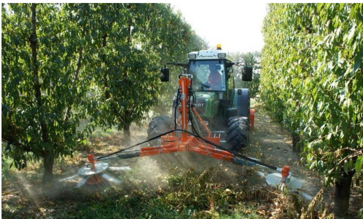
Slika 7. Traktorski priključak za sakupljanje granja RINIERI AN2 [5]
