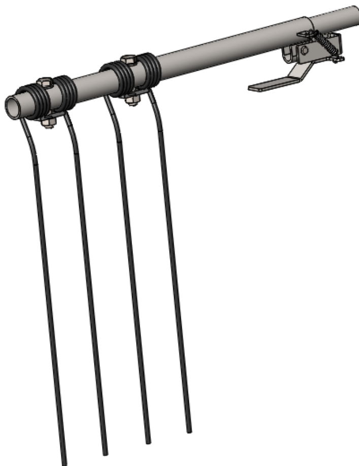
Slika 67. Metlica za okretanje sijena
