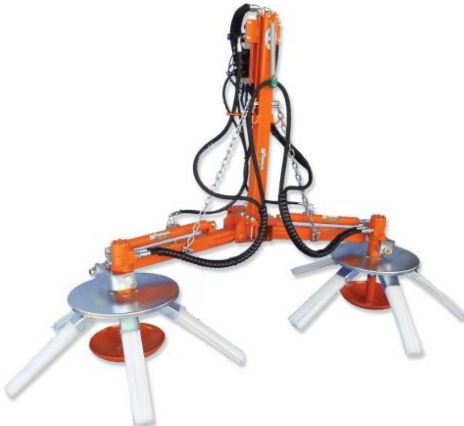
Slika 8. traktorski priključak RINIERI AN2 sa uvučenim cilindrima [5]
