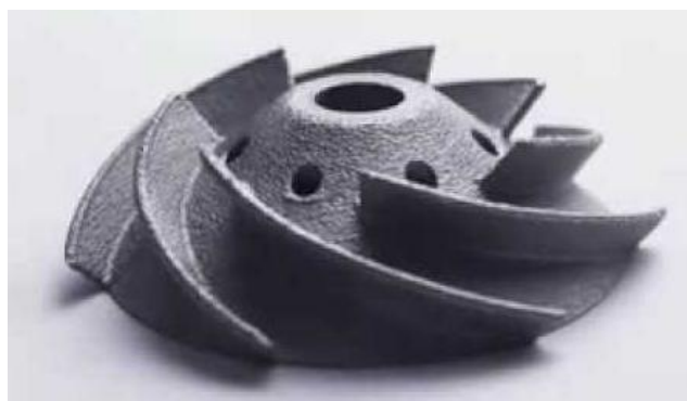
Slika 7. Komponenta napravljena Arcamovim EBM uređajem [10]
