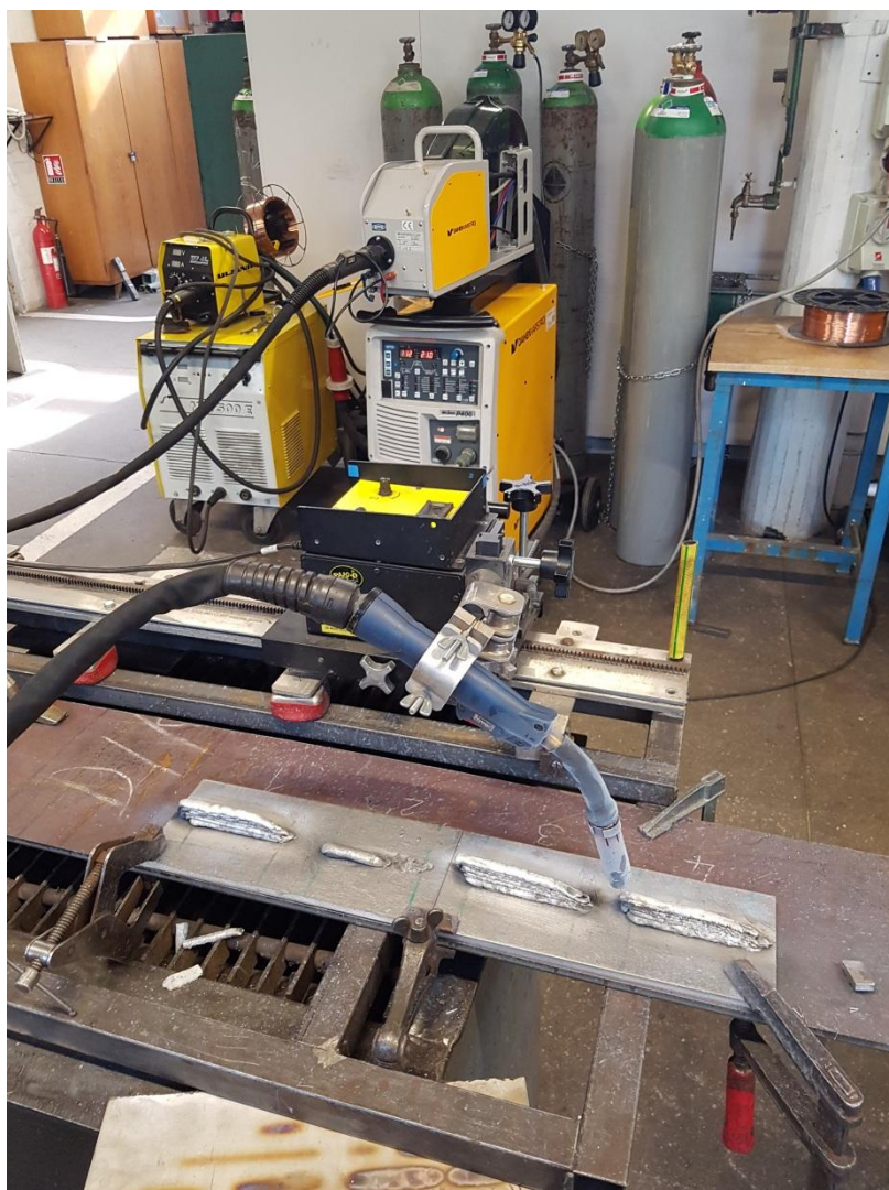
Slika 29. Postav eksperimenta i opreme za WAAM postupak
