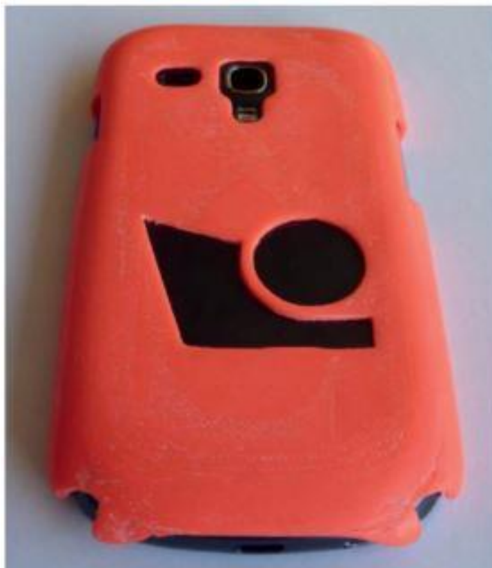
Slika 3.7. Tvorevina nastala postupkom FDM [23]
