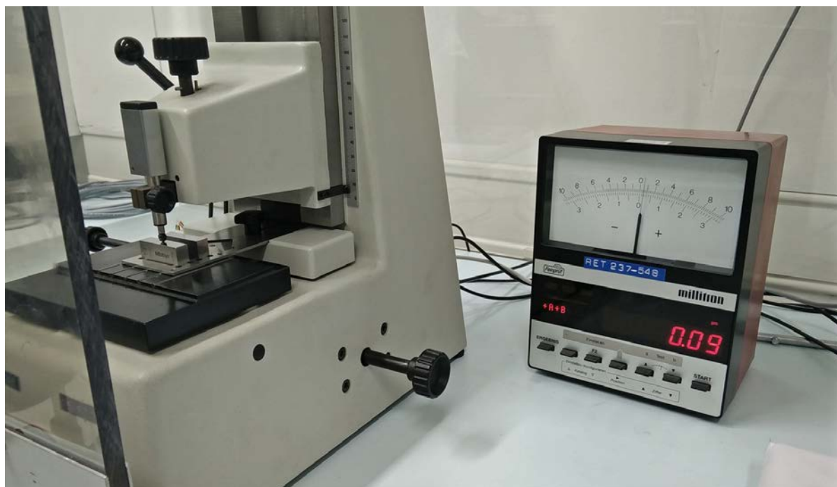
Slika 2.2 Induktivno ticalo (lijevo) i Millitron (desno) u laboratoriju za precizna mjerenja dužina
