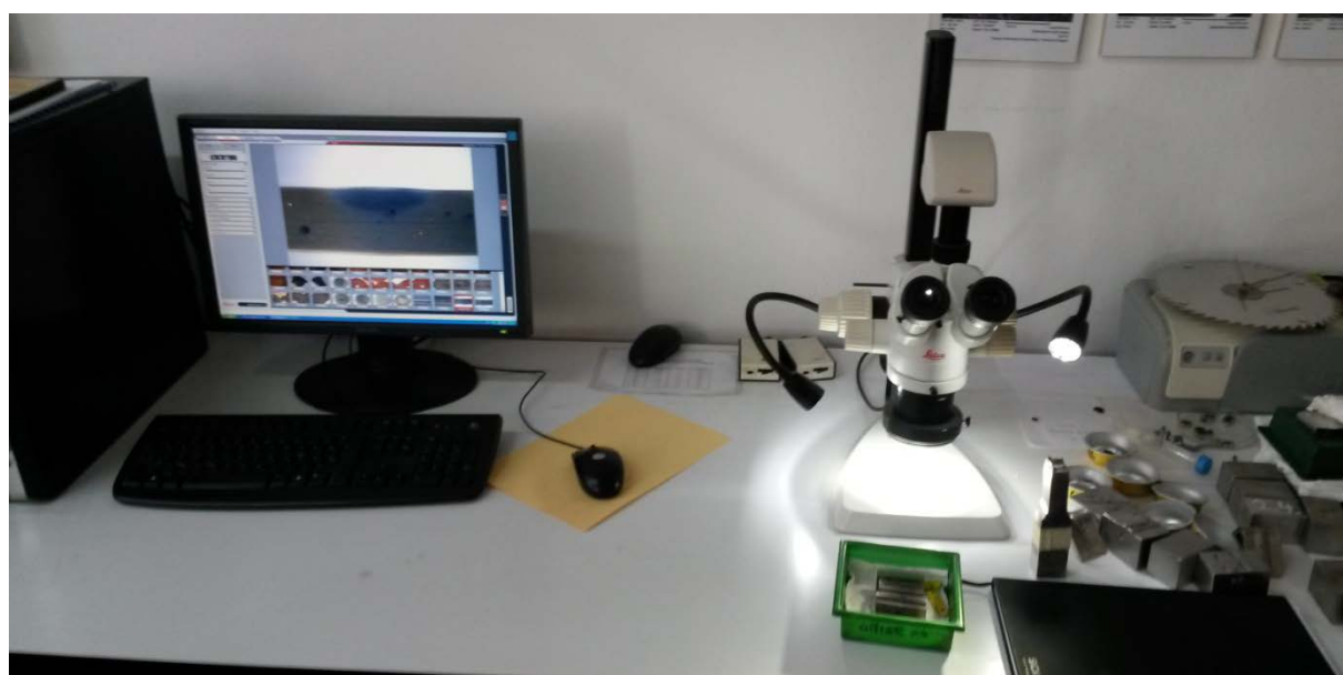
Slika 59. Radno mjesto s mikroskopom Leica MZ6
