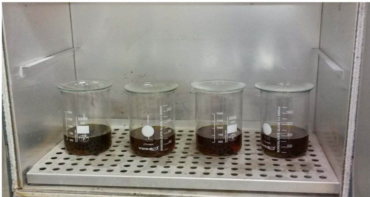
Slika 63. Uzorci pripremljeni za ispitivanje prema ASTM G48-03
