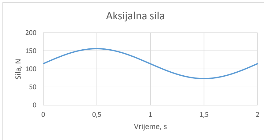
Slika 85. Aksijalna sila na uniball -u spone volana
