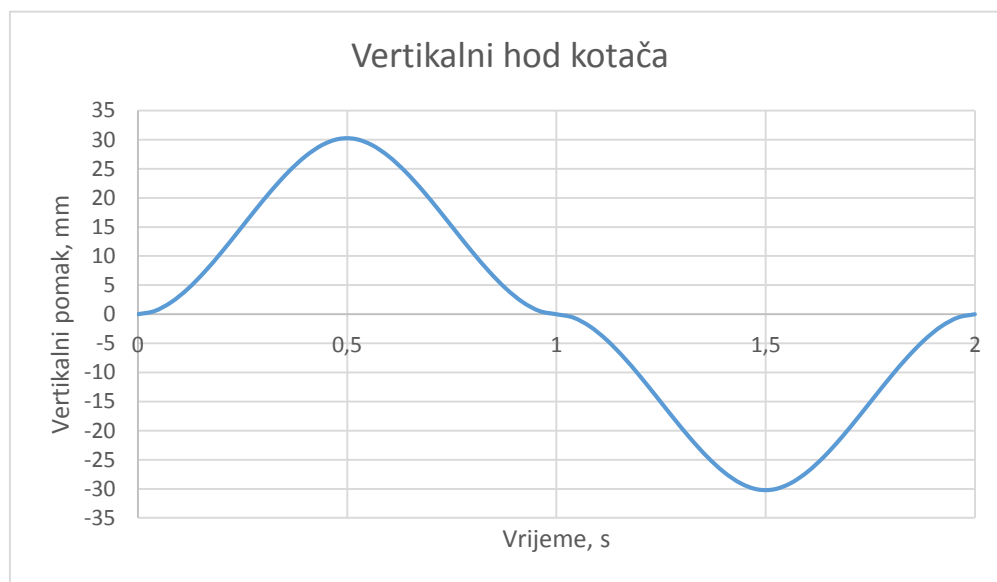
Slika 101. Vertikalni hod stražnjeg kotača
