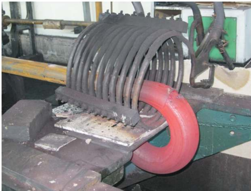
Slika 4. Cijevni luk dobiven hamburškim postupkom
