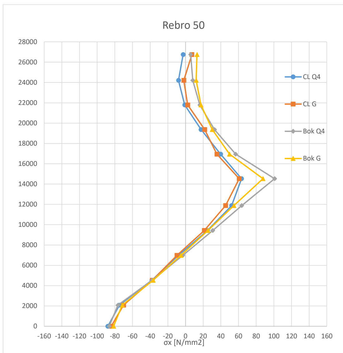
Slika 14. Usporedba distribucije primarnih naprezanja na rebru 50
