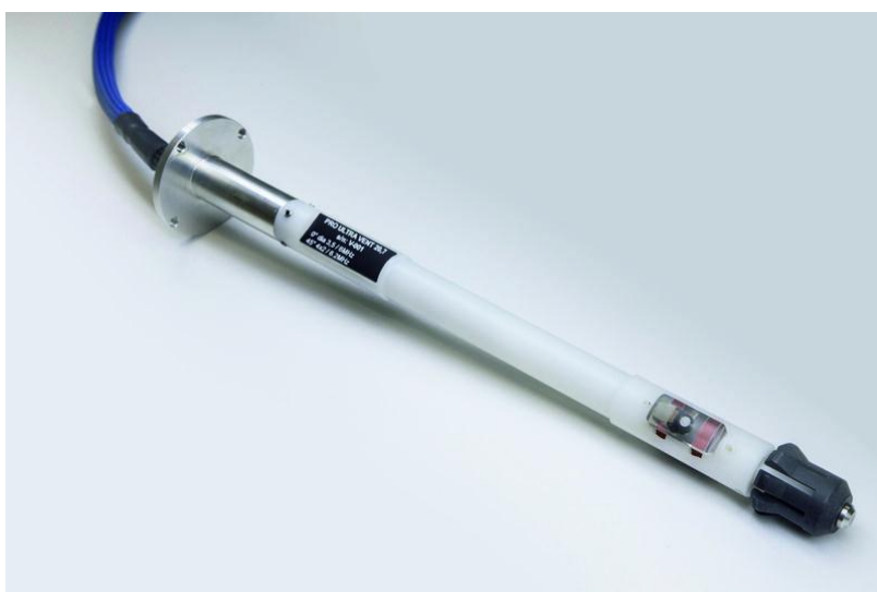
Slika 9. Ultrazvučna sonda za ispitivanje ventila tlačnika nuklearnog reaktora [11]
