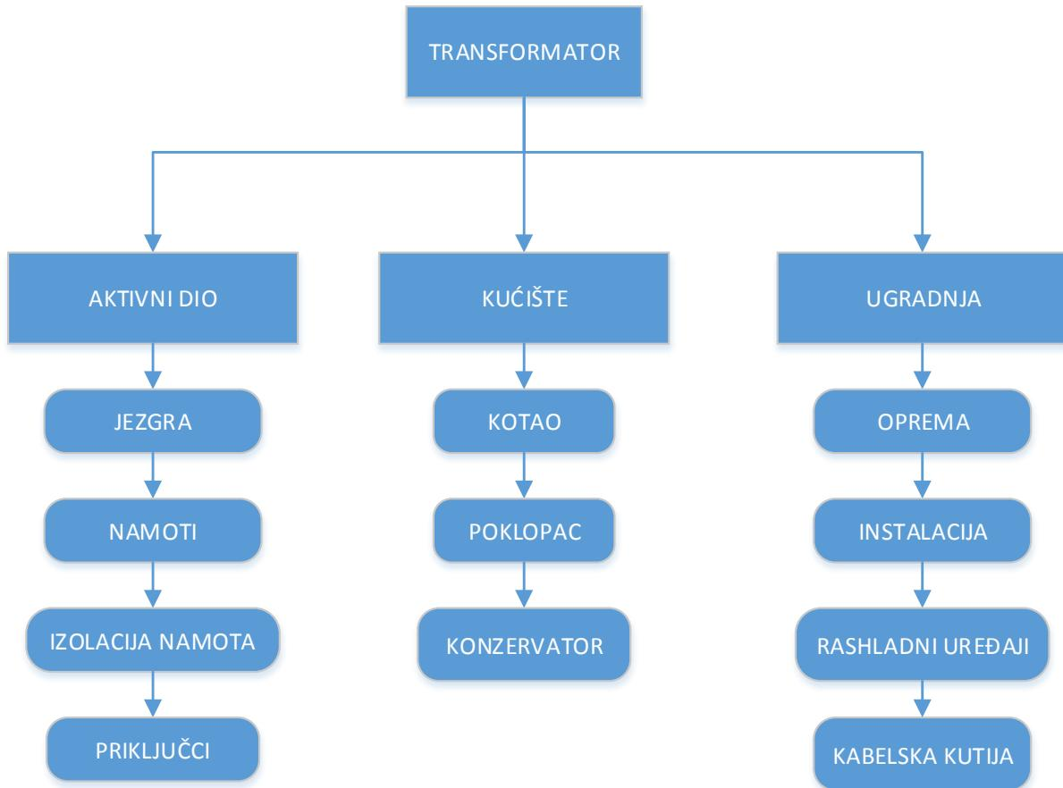
Slika 2.2 Osnovni dijelovi transformatora
