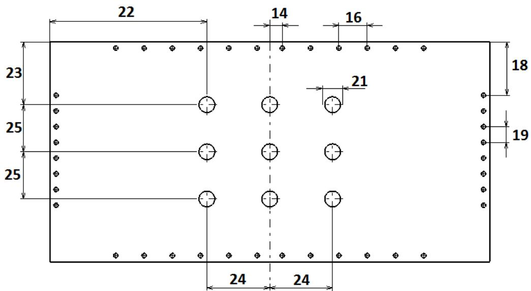
Slika 7.34 Parametri uvodne ploče
