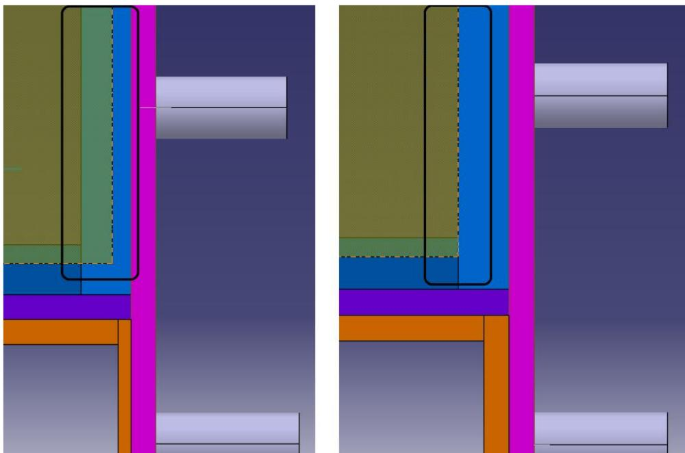
Slika 7.23 Parametar 10 (Detalj B- lijevo je izveden preklop s 5mm, a desno je preklop 0mm)
