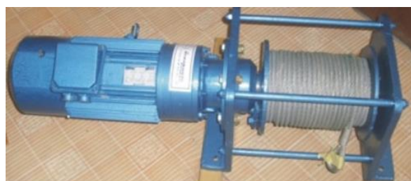
Slika 12. Dizanje pomoću bubnja i čeličnog užeta
