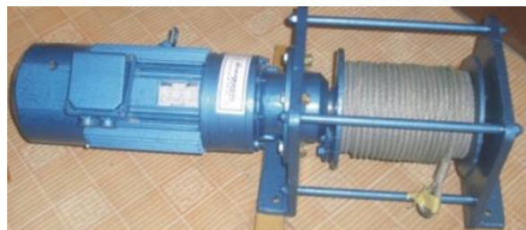
Slika 12. Dizanje pomoću bubnja i čeličnog užeta
