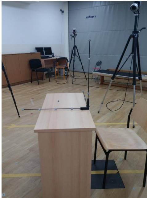
Slika 20. Određivanje koordinatnog sustava u radnom volumenu
