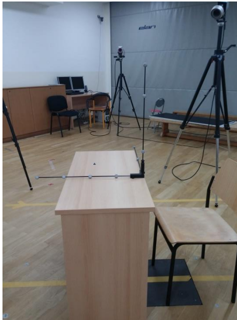
Slika 20. Određivanje koordinatnog sustava u radnom volumenu
