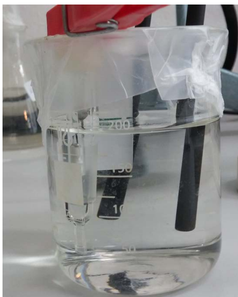
Slika 40. Prikaz uzorka uronjenog u elektrolit prije početka elektrokemijskog ispitivanja
