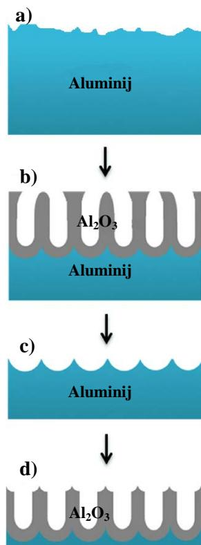
**Slika 14.** Shematski prikaz predobrade anodizacijom [29]; a) stanje površine prije anodizacije; b) oksidni sloj nakon prve anodizacije, c) stanje površine nakon anodizacije; d) oksidni sloj nakon druge anodizacije
