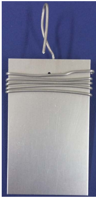
Slika 27. Uzorak pripremljen elektrokemijsku oksidaciju (anodizaciju)
