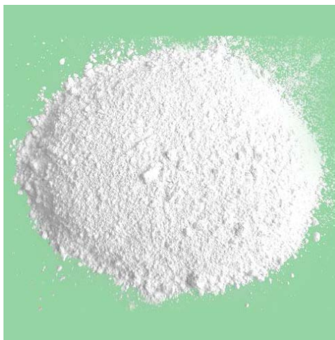
Slika 3. Industrijska glinica pogodna za elektrolitičko dobivanje aluminija [7]
