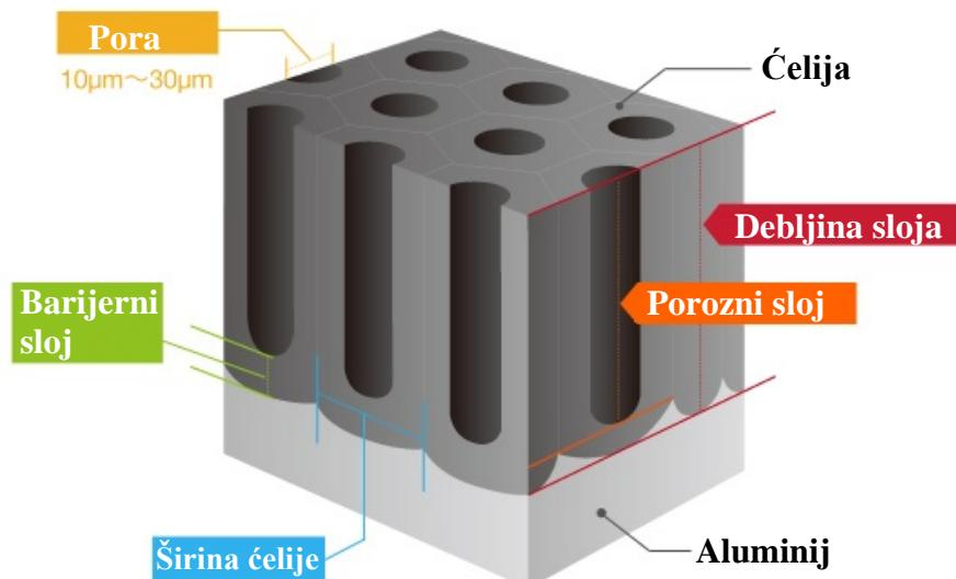
**Slika 12. Shematski prikaz poroznog oksidnog sloja [25]**
