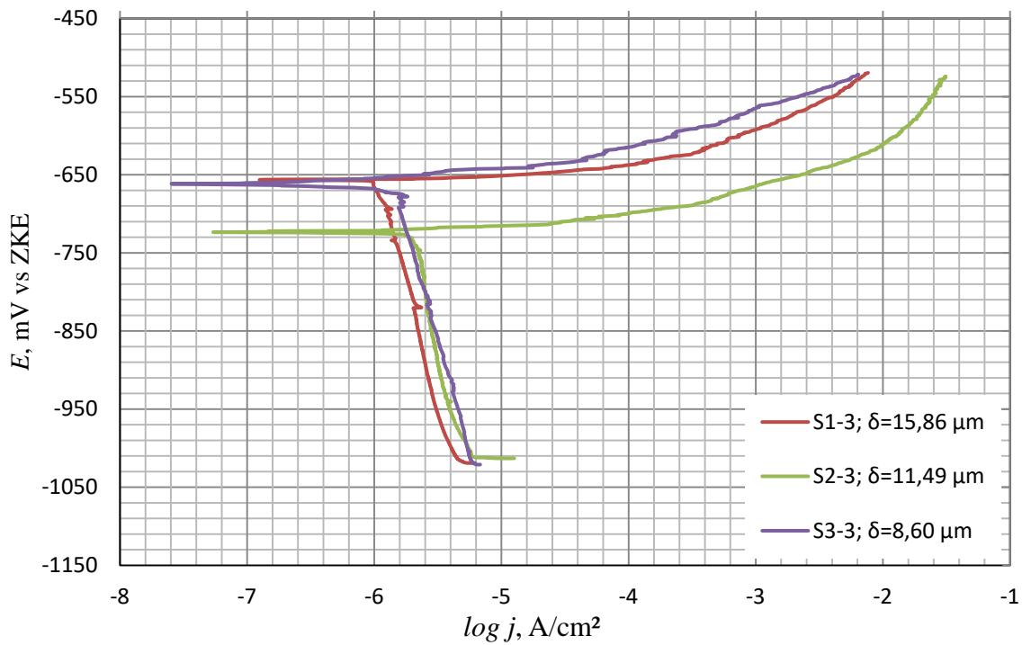
**Slika 49.** Dijagram Tafelove polarizacije za uzorke anodizirane u sulfatnoj kiselini te silirane u destiliranoj vodi s dodatkom inhibitora
