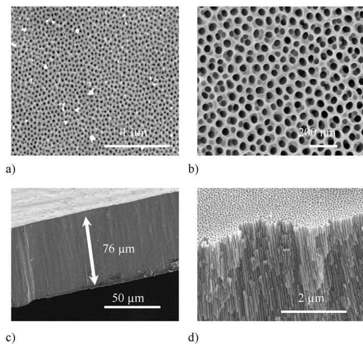
**Slika 13. Porozni oksidni sloj snimljen SEM mikroskopom [27]; a) anodizacija u 5 %-tnoj sulfatnoj kiselini; b) anodizacija u 2,7 %-tnoj oksalnoj kiselini; c) anodizacija u 20 %-tnoj sulfatnoj kiselini; d) anodizacija u 3 %-tnoj sulfatnoj kiselini**
