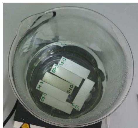
Slika 36. Proces siliranja
