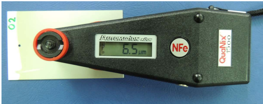
Slika 31. Mjerenje debljine prevlake pomoću uređaja QuaNix 1500
