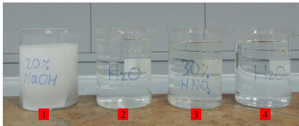
**Slika 25. Postupak predobrade aluminijevog uzorka prije elektrokemijske oksidacije**
