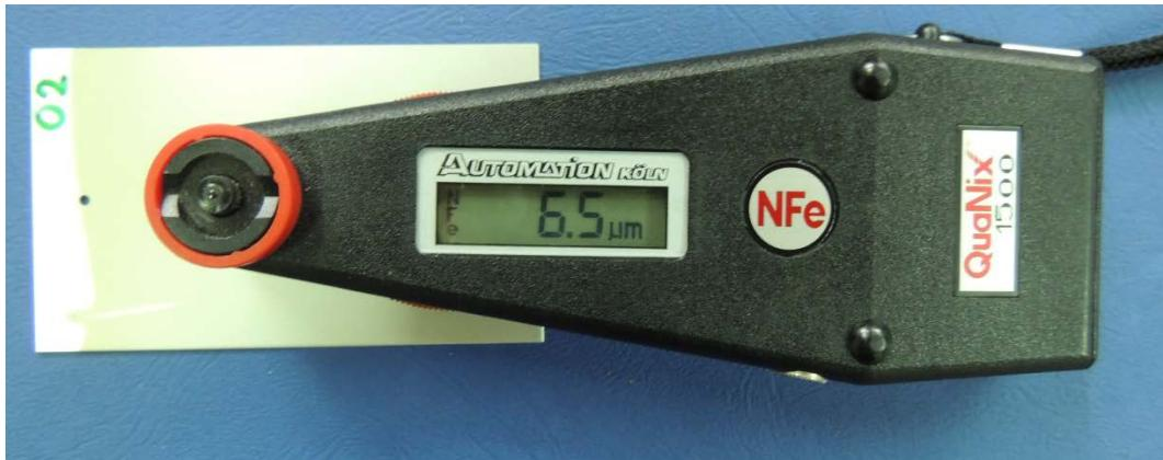
Slika 31. Mjerjenje debljine prevlake pomoću uređaja QuaNix 1500
