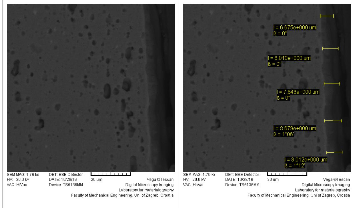
**Tablica 9. SEM analiza oksidnih prevlaka na uzorcima - nastavak****Uzorak O3; vrijeme anodizacije: 20 min; prosječna debljina oksidne prevlake: 3,421 µm**
