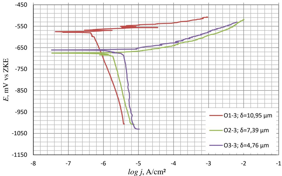
**Slika 52. Dijagram Tafelove polarizacije za uzorke anodizirane u oksalnoj kiselini te silirane u destiliranoj vodi s dodatkom inhibitora**
