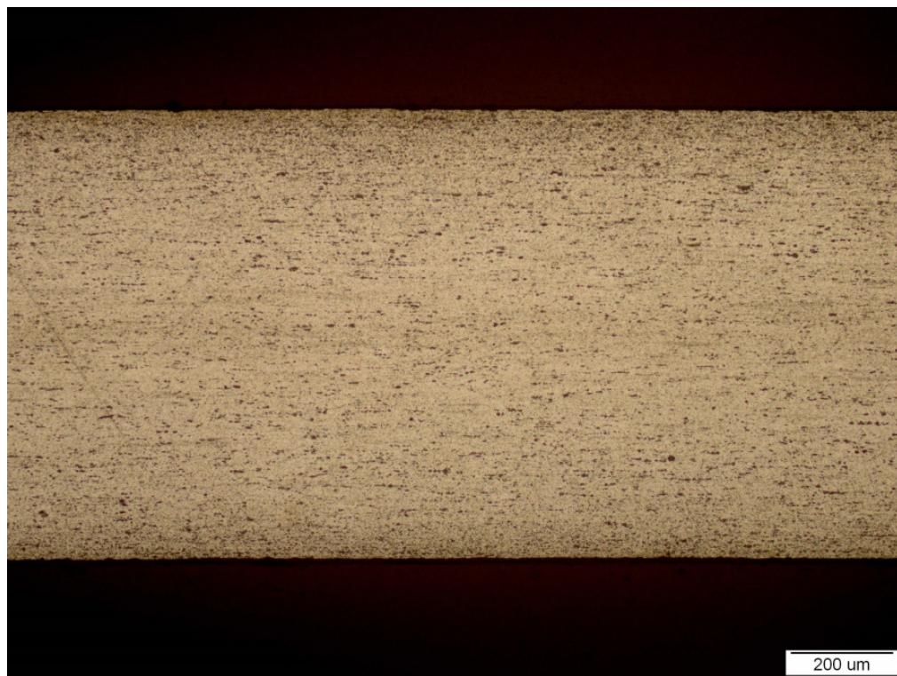
**Slika 23. Mikrostruktura legure aluminija 5086 u poliranom i nagriženom stanju, povećanje 100x**
