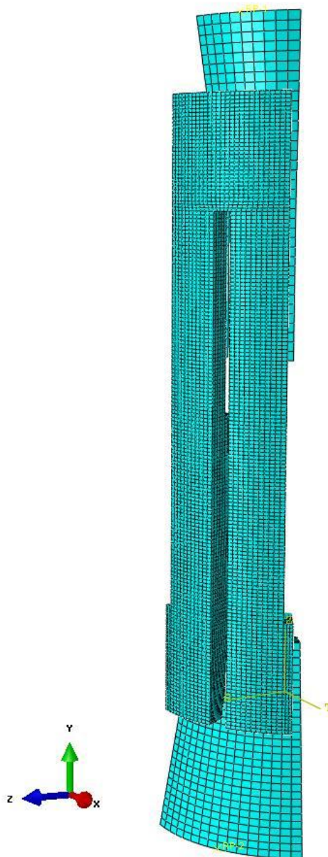
Slika 42. Diskretizacija prvog konstrukcijskog rješenja 1/6 modela s C3D20R konačnim elementima
