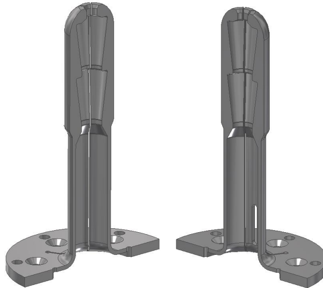
Slika 67. Dva identična elementa prsta
