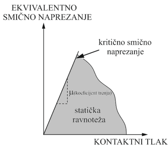
Slika 24. Dijagram statičke ravnoteže do kritičnog smičnog naprezanja
