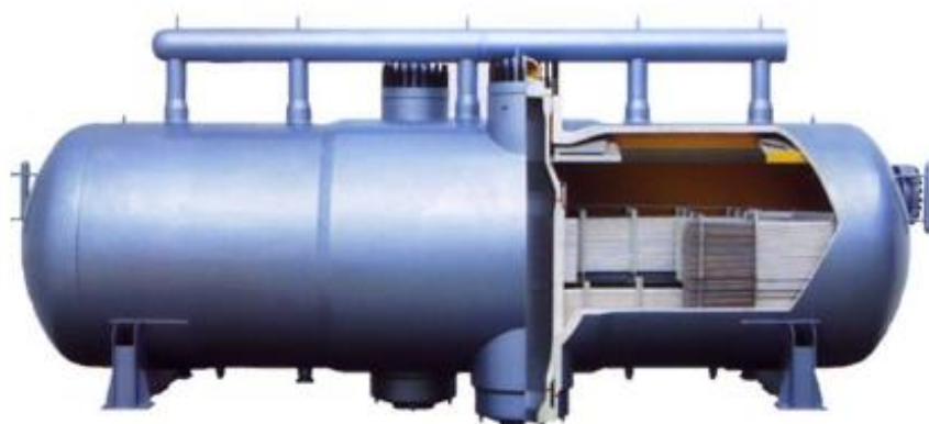
Slika 2. Horizontalni parogenerator VVER reaktora [3]
