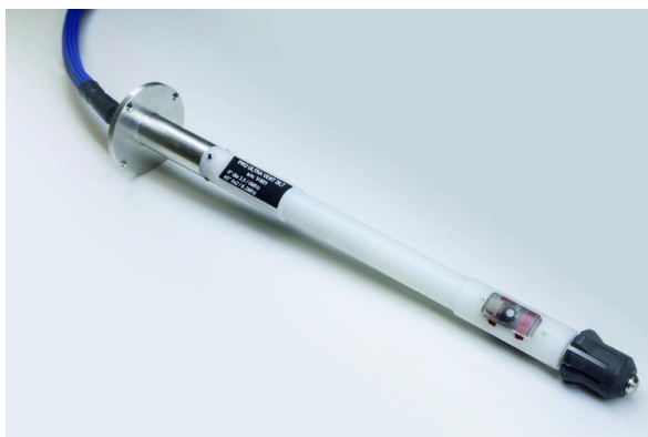
Slika 6. Sonda za ispitivanje ventila reaktora ultrazvučnom metodom [4]
