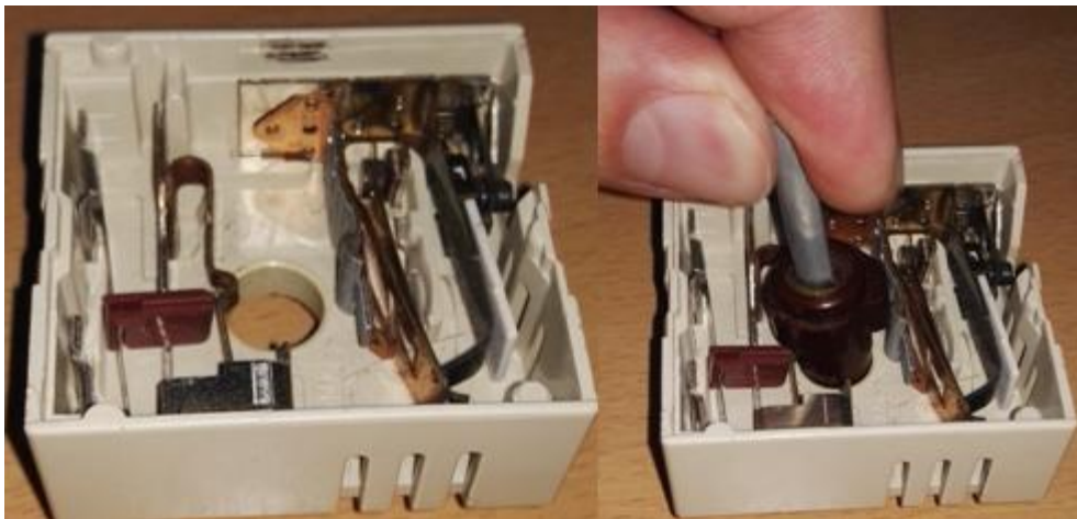
Slika 30. Umetanje vrtila u kućište termoregulatora
