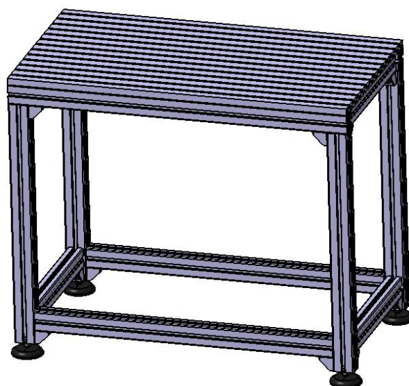
Slika 104. CAD model stola za „UR5” robote izrađenog u laboratoriju
