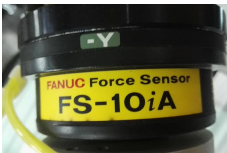
Slika 31. Senzor sile „Fanuc FS-10iA”
