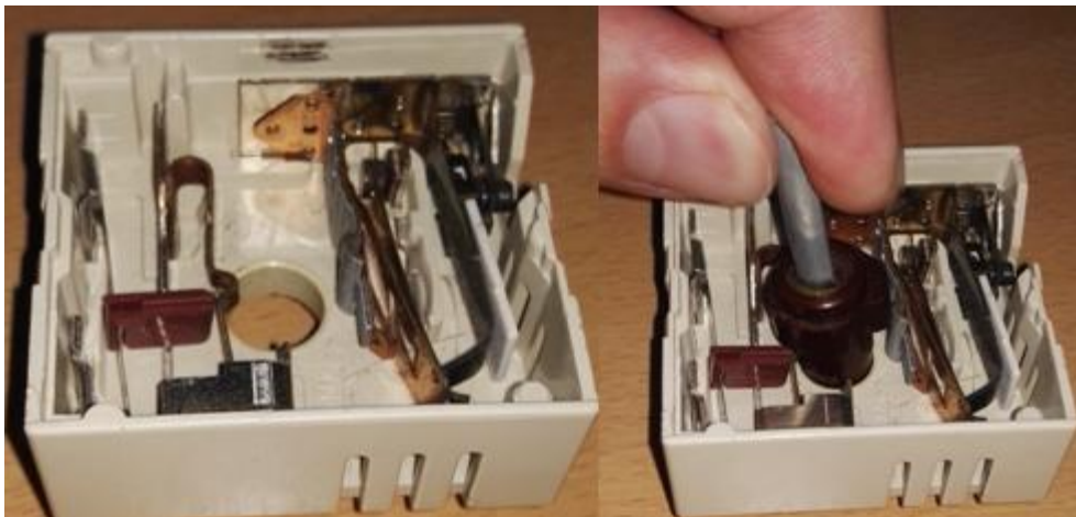
Slika 30. Umetanje vratila u kućište termoregulatora
