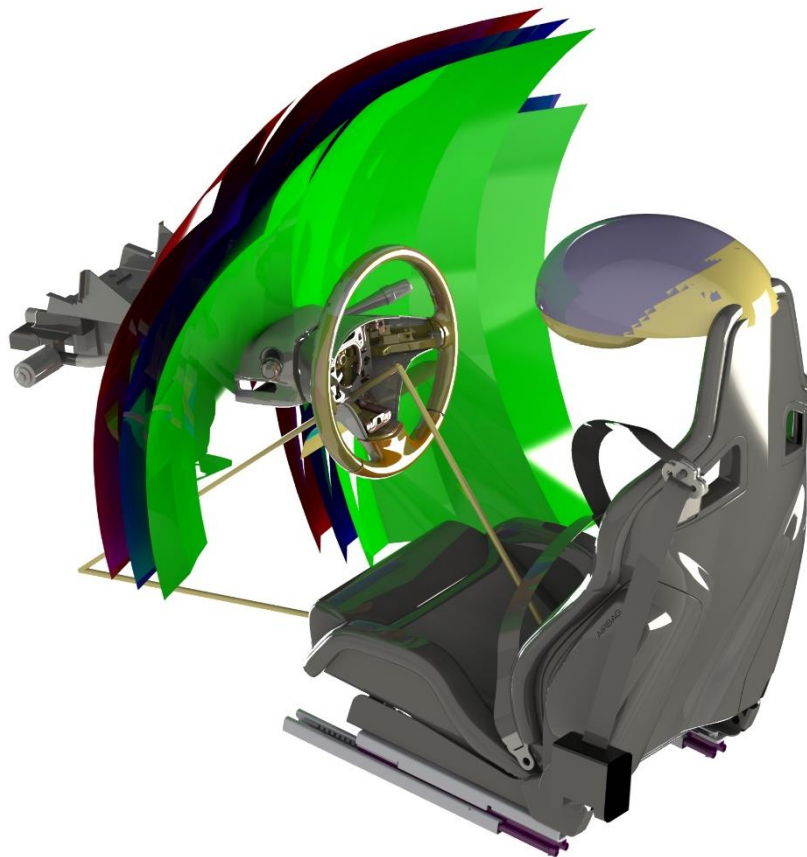
Slika 42. Proračunski model sa ravninama zakrivljenosti
