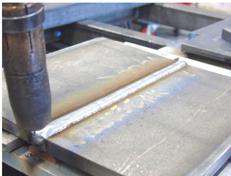
Slika 36. Izgled trećeg prolaza na uzorku 3
