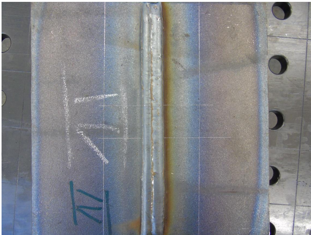
Slika 37. Označavanje ploče za izrezivanje uzoraka
