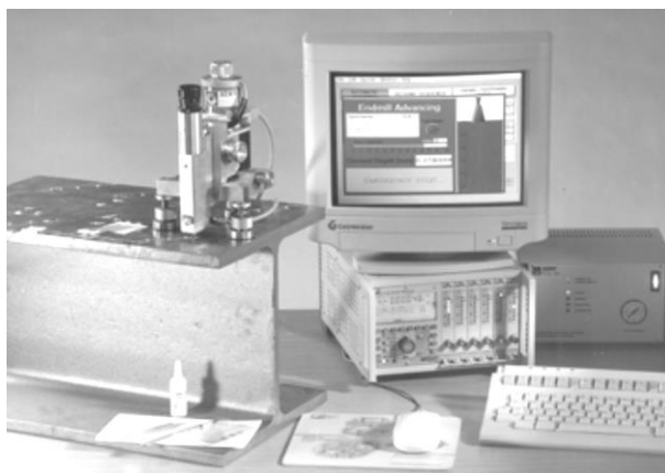
Slika 19. Oprema za bušenje [14]
