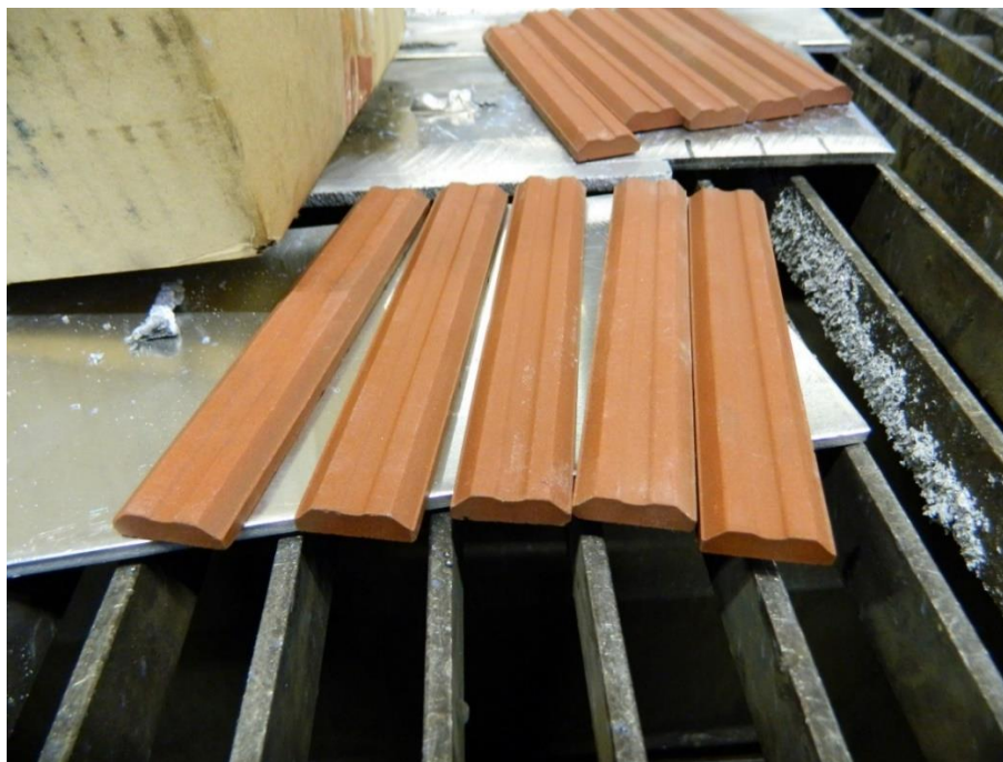
Slika 25. Keramičke podloge za korijenski zavar
