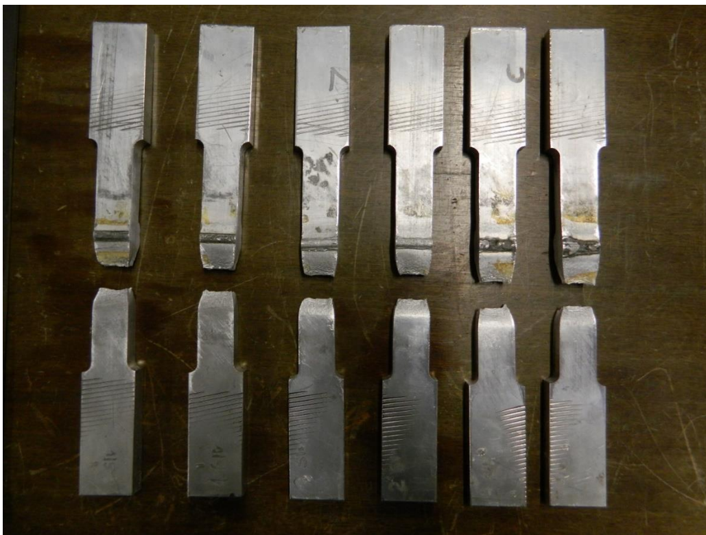
Slika 33. Uzorci nakon statičkog vlačnog ispitivanja
