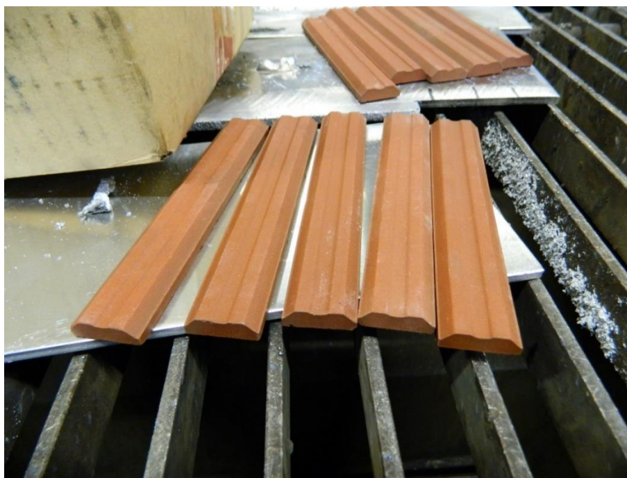
Slika 25. Keramičke podloge za korijenski zavar
