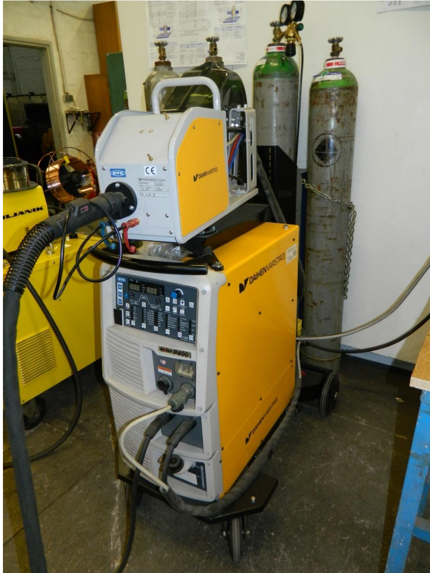
Slika 21. Izvor struje za zavarivanje DAIHEN VARSTROJ WB-P400
