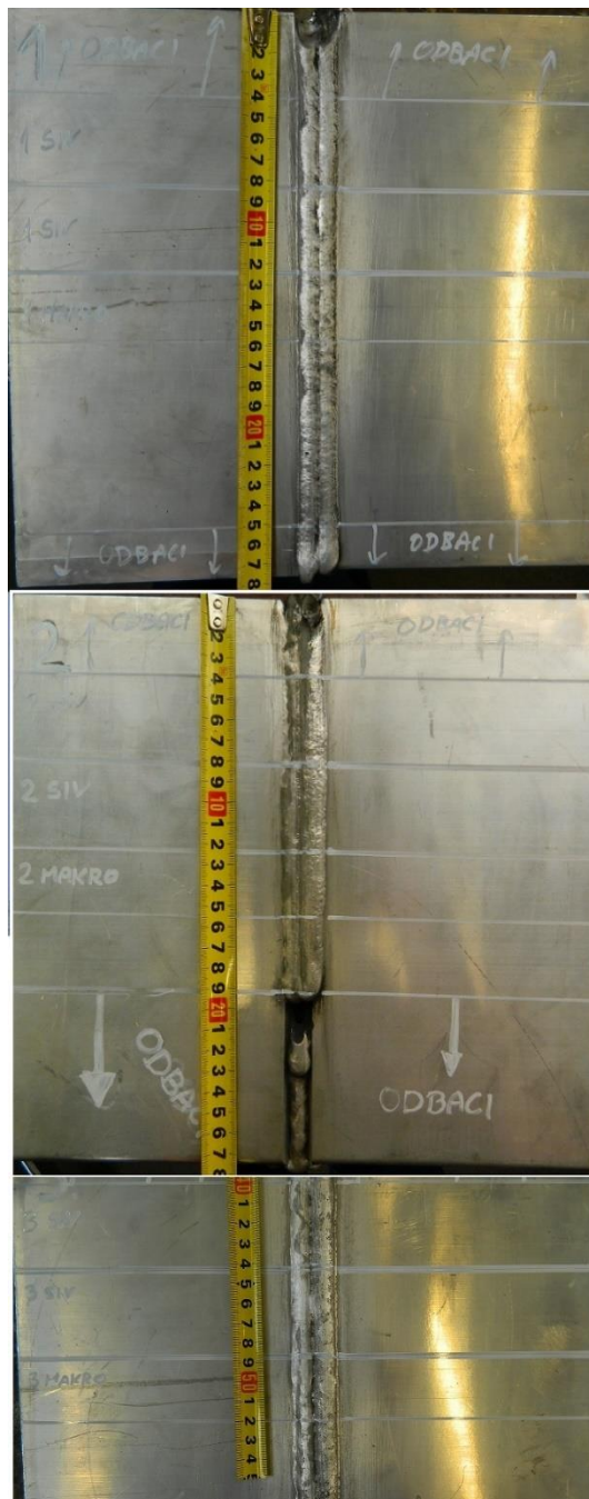
Slika 28. Priprema ispitnih uzoraka za rezanje
