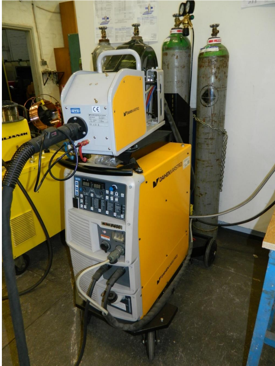
Slika 21. Izvor struje za zavarivanje DAIHEN VARSTROJ WB-P400
