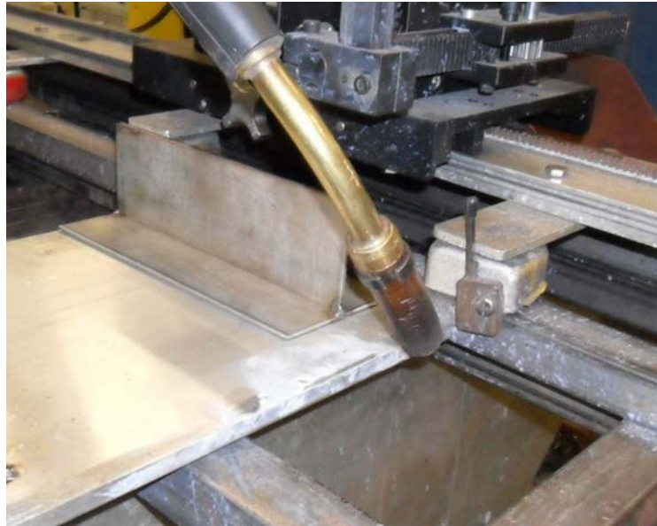
Slika 45. Postav eksperimenta za zavarivanje ispitnog T-spoja
