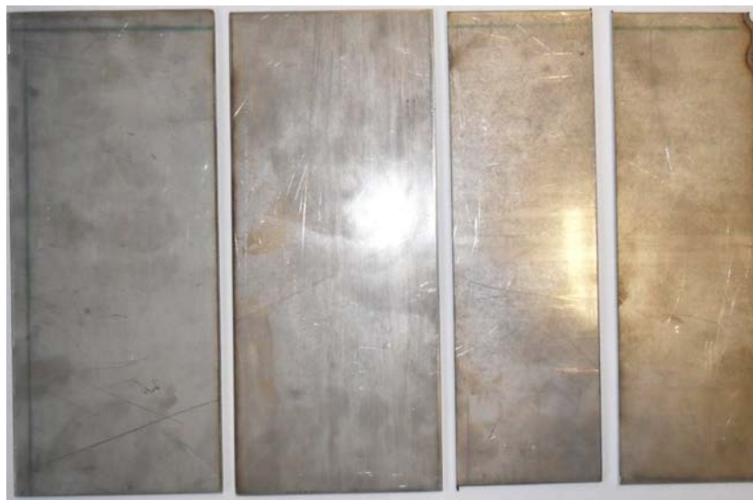
Slika 39. Izrezane ploče osnovnog materijala
