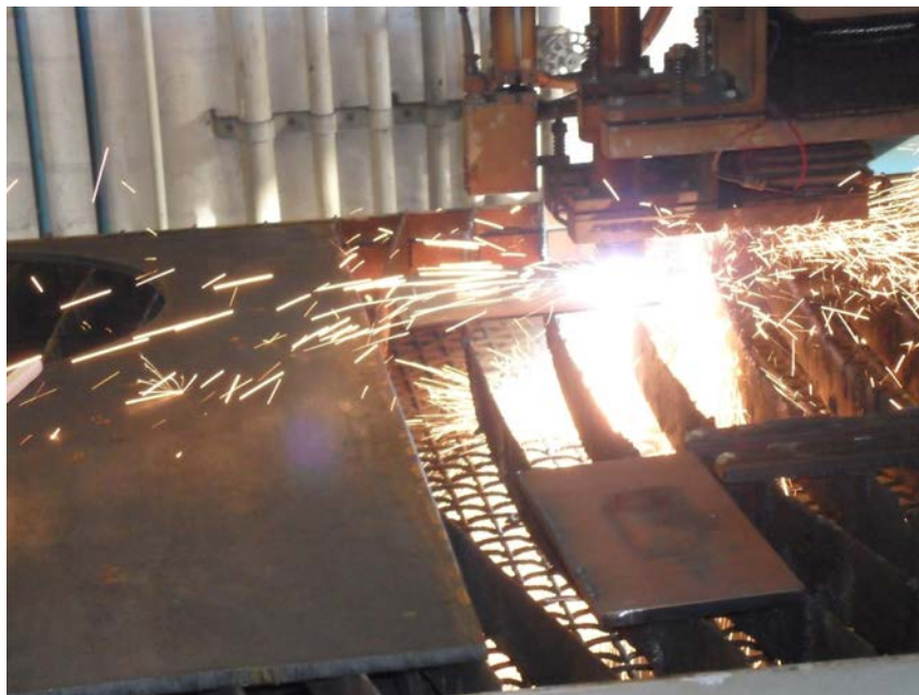
Slika 40. Izrezivanja ploča osnovnog materijala na plazma rezačici
