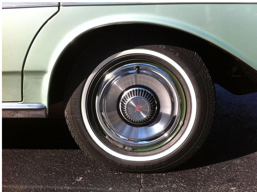
Slika 3.2 Pokrivalo od nehrđajućeg čelika[14]
