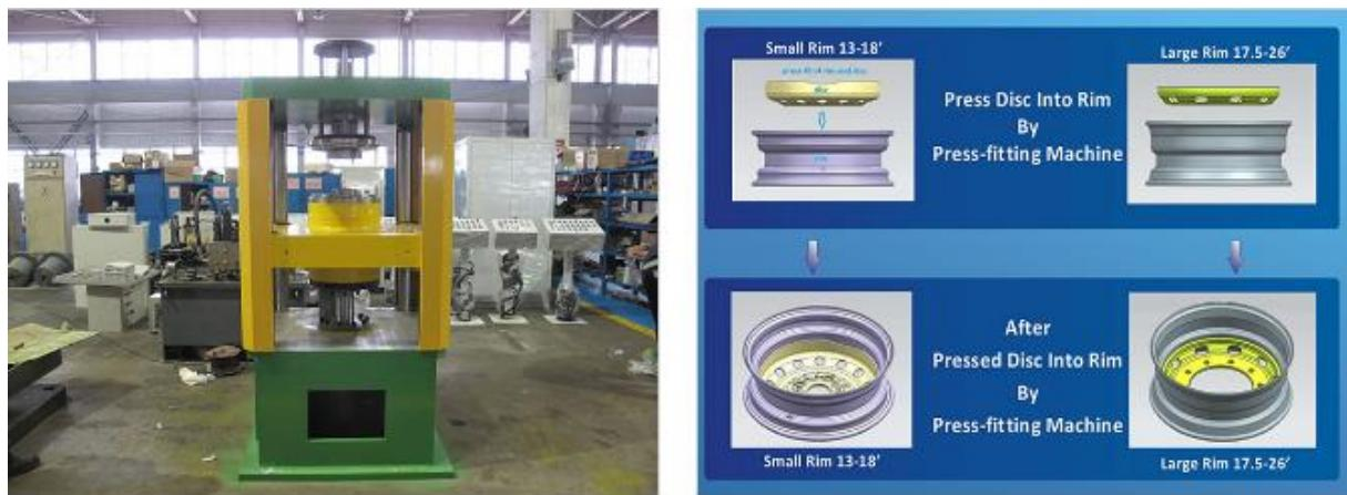
Slika 4.9 Pritisak diska u naplatak, zavarivanje [17]
