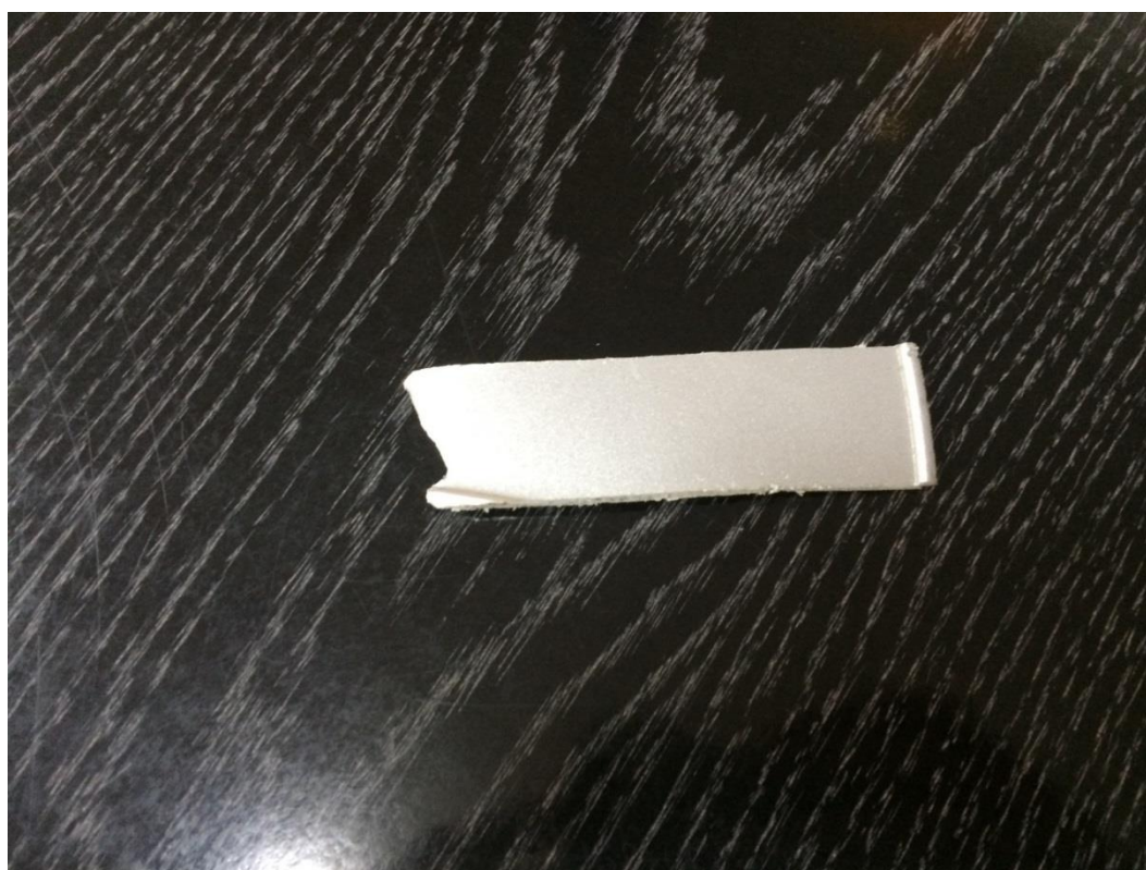
Slika 7.15 Polimerni dio za mjerenje otpornosti na abrazijsko trošenje
