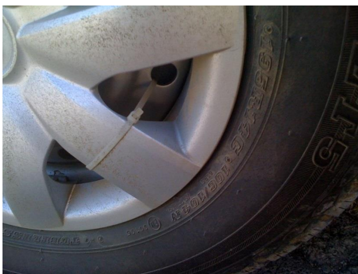
Slika 3.3 Pokrivalo pričvršćeno plastičnom vezicom da bi se spriječilo ispadanje [14]
