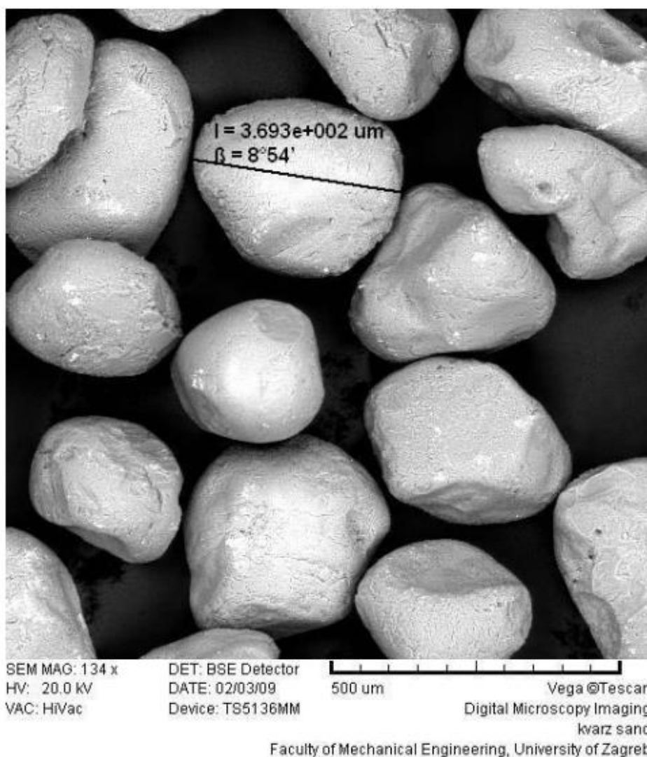
Slika 7.6 Zrnca silicij oksidnog (kvarcnog) pijeska snimljena pretražnim elektronskim mikroskopom (SEM-om) [30]
