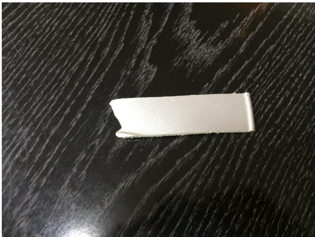
Slika 7.15 Polimerni dio za mjerjenje otpornosti na abrazijsko trošenje
