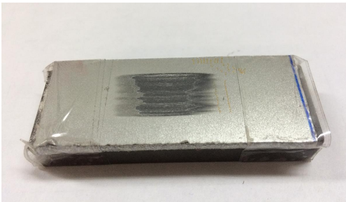
Slika 7.16 Ispitni uzorak aluminijski na završetku ispitivanja
