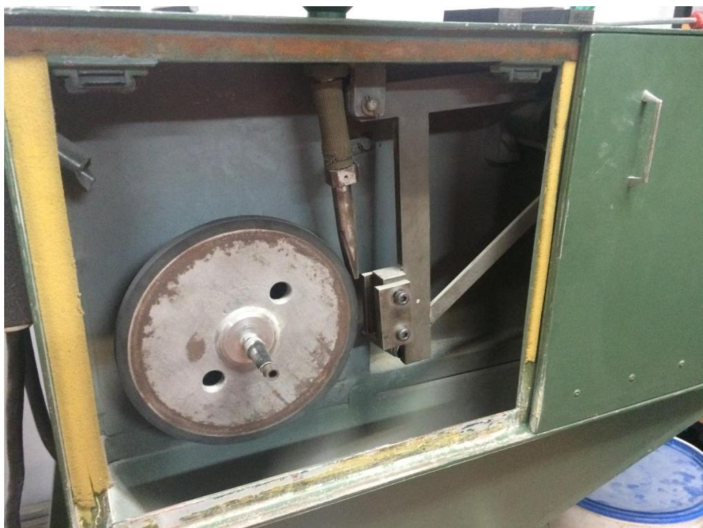
Slika 7.12 Uredaj za mjerjenje otpornosti na abrazijsko trošenje metodom “suhu pijsak/gumeni kotač“
