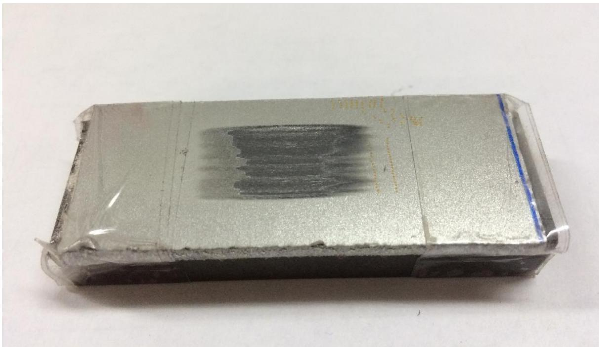
Slika 7.16 Ispitni uzorak aluminija na završetku ispitivanja
