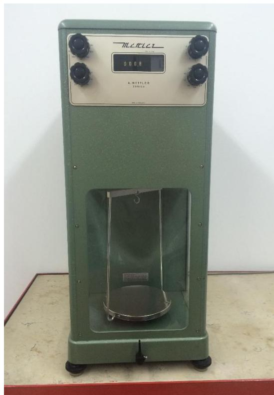
Slika 7.10 Vaga korištena za vaganje uzoraka nakon ciklusa erozijskog trošenja
