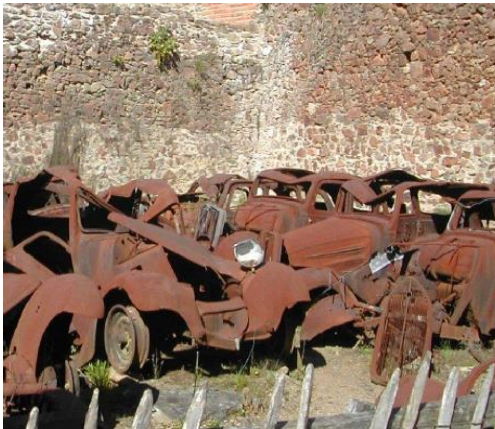
Slika 5. Primjer opće korozije [3]
