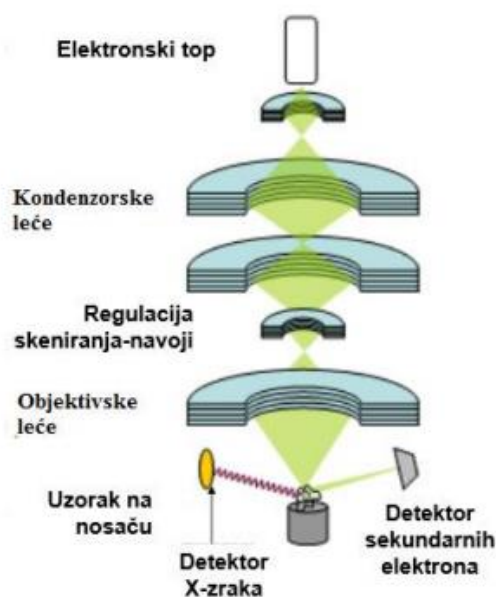
Slika 23. Princip rada SEM-a [22]
