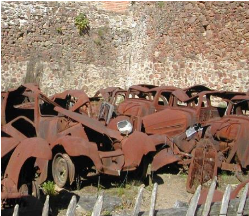
Slika 5. Primjer opće korozije [3]
