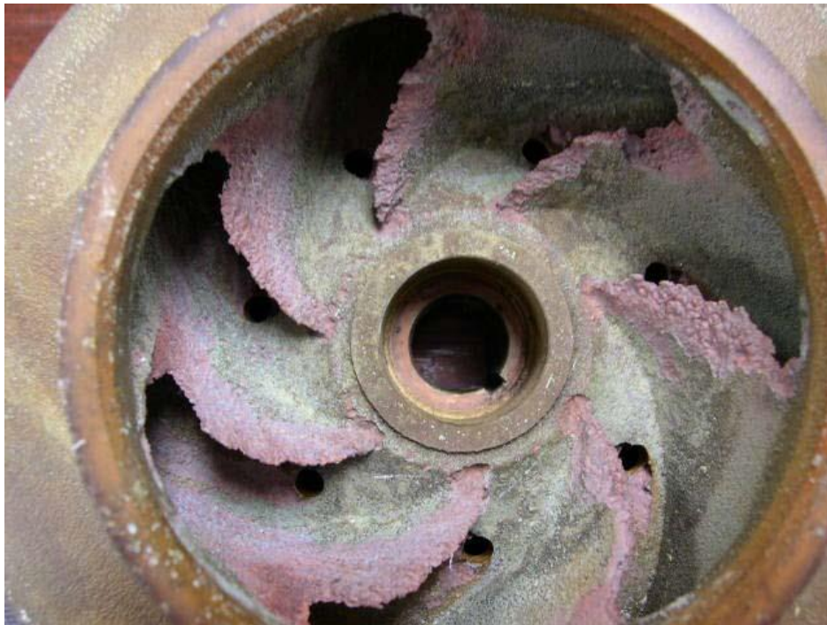
Slika 9. Erozijska korozija na lopaticama [13]
