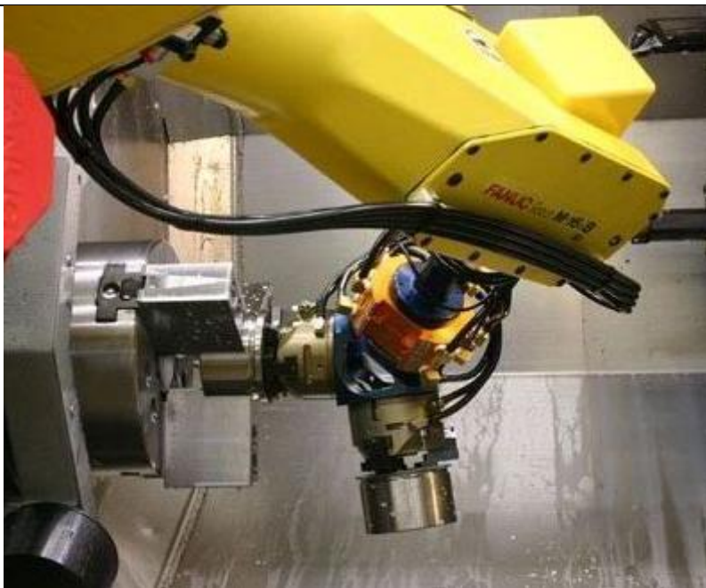
Slika 8 Skidanje izradka s CNC stroja [10]
