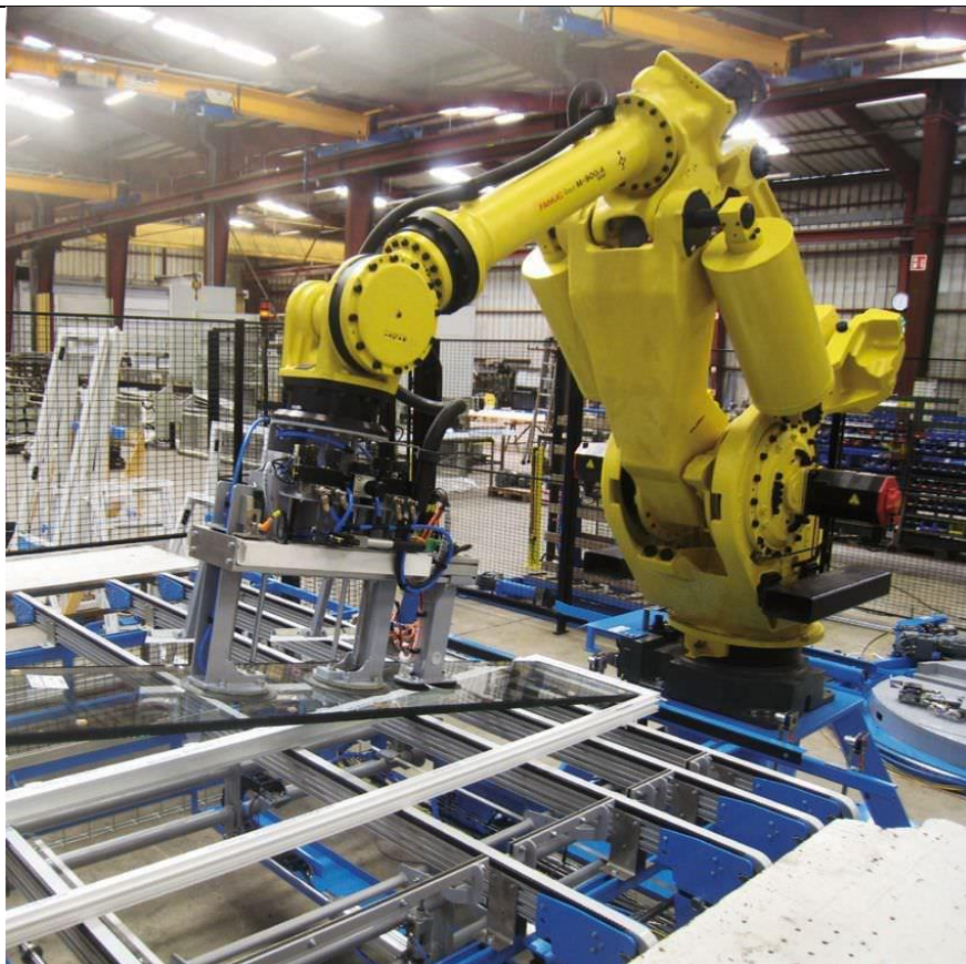
Slika 12 Montaža stakla upotrebom robota [12]
