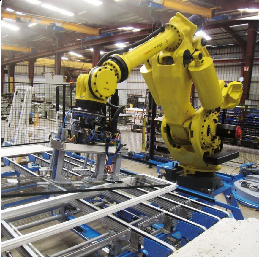
Slika 12 Montaža stakla upotrebom robota [12]
