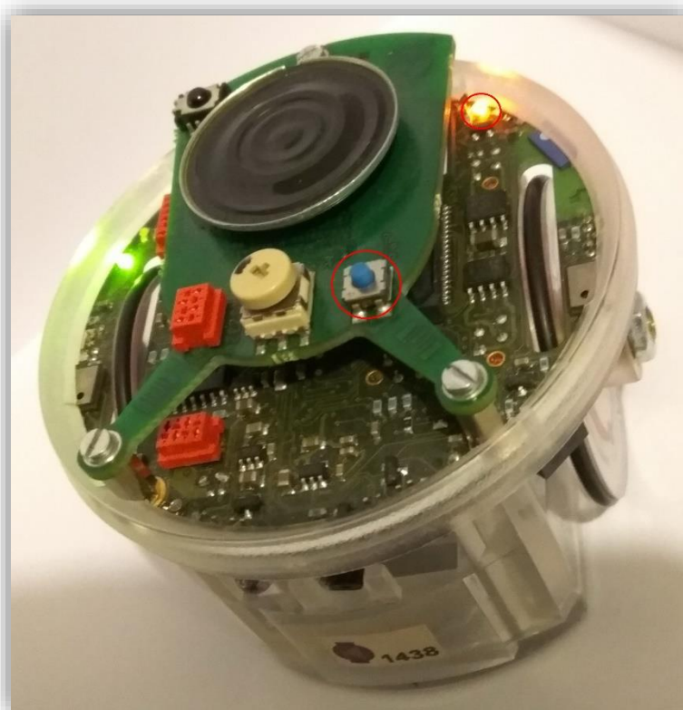
Slika 24. Narančasti LED indikator i reset tipka
