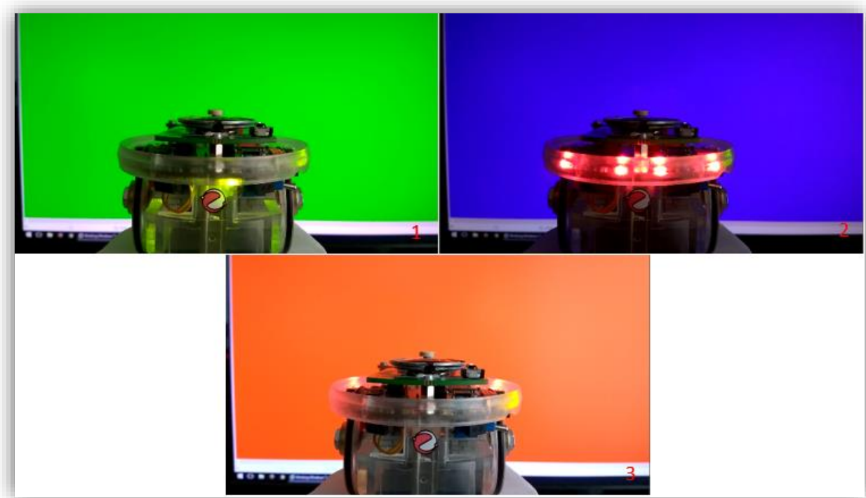
Slika 66. Prepoznavanje boja: robot je uspješno prepoznao 1) zelenu boju, 2) plavu boju i 3) crvenu boju
