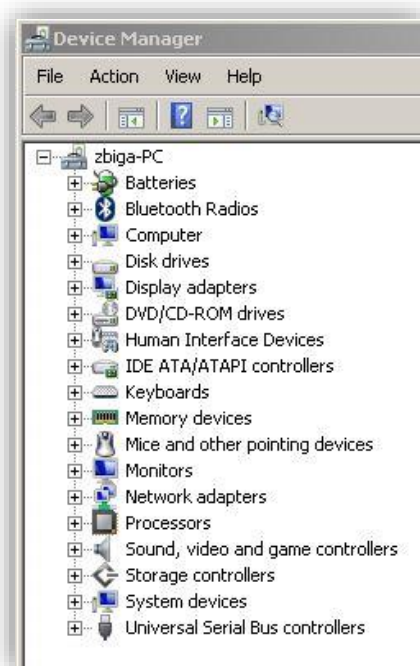
Slika 18. Device manager – nema sekcije Ports (COM & LPT)
