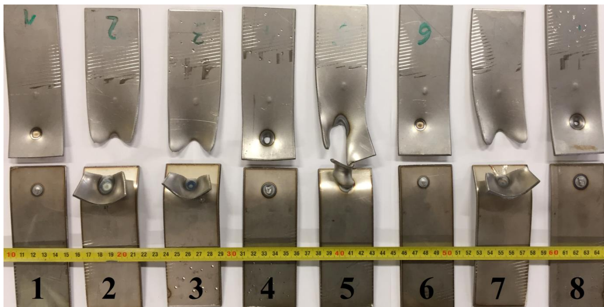
Slika 47. Uzorci nakon ispitivanja na kidalici
