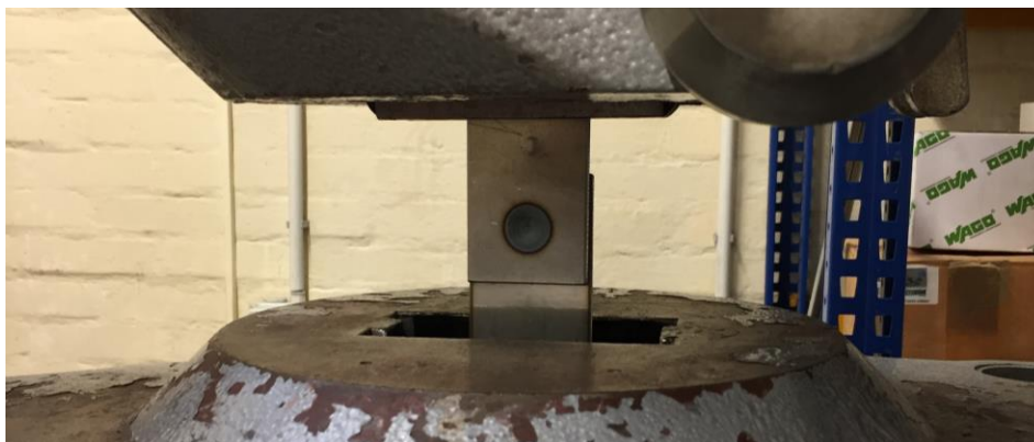
Slika 45. Uzorak stegnut u čeljusti kidalice
