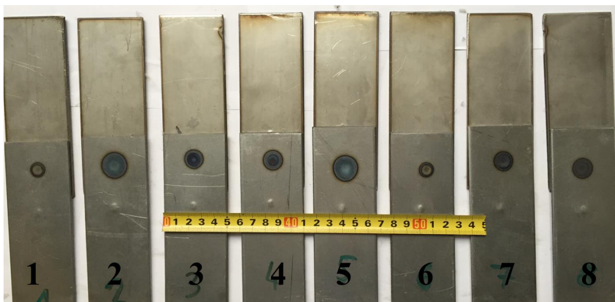
Slika 39. Lice zavarene točke (kontakt: radni komad – gornja elektroda)
