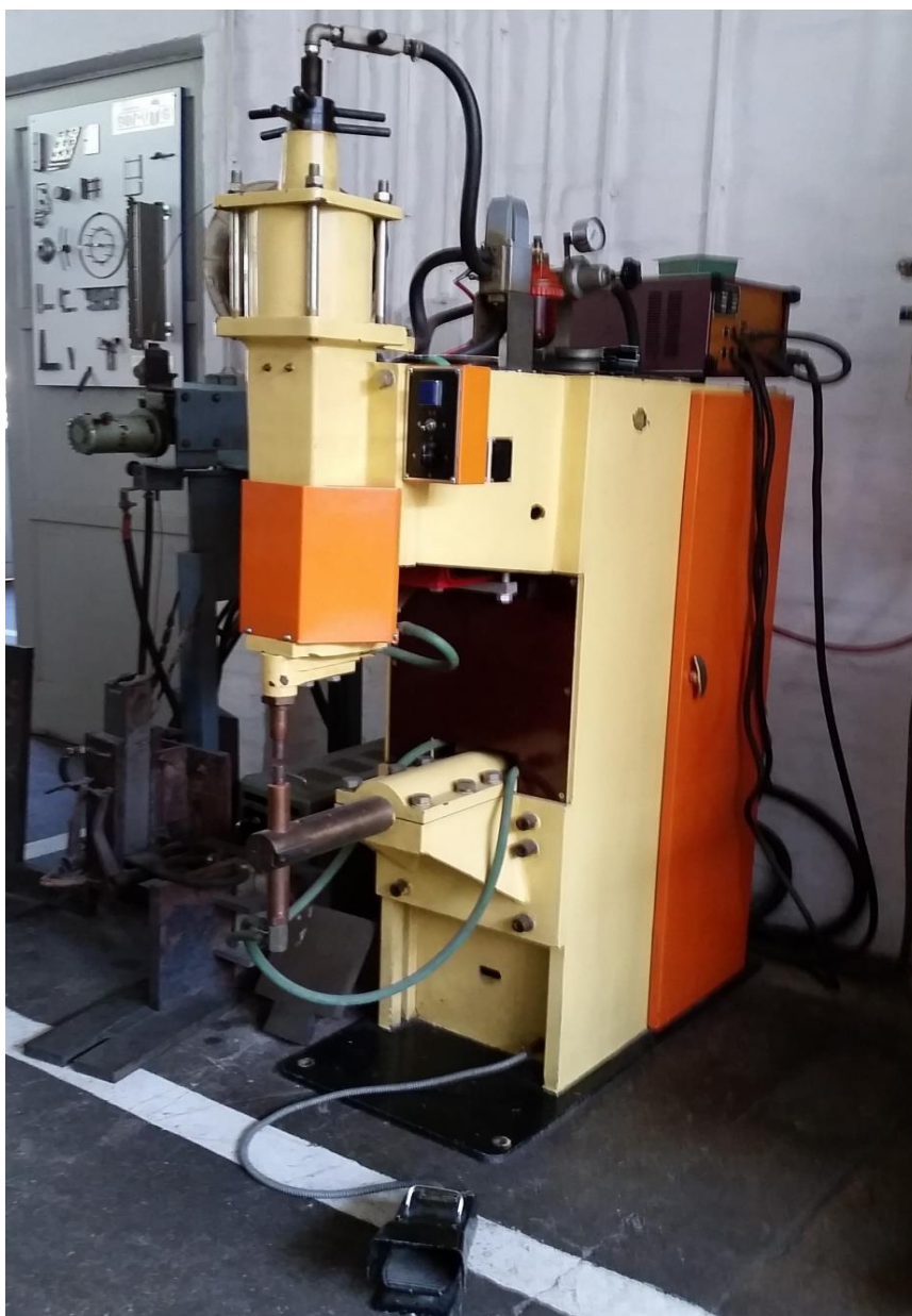
Slika 25. Stroj za elektrootporno točkasto zavarivanje na kojem je izveden eksperiment
