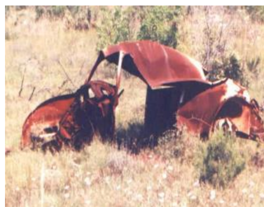
Slika 25. Primjer opće korozije [17]
