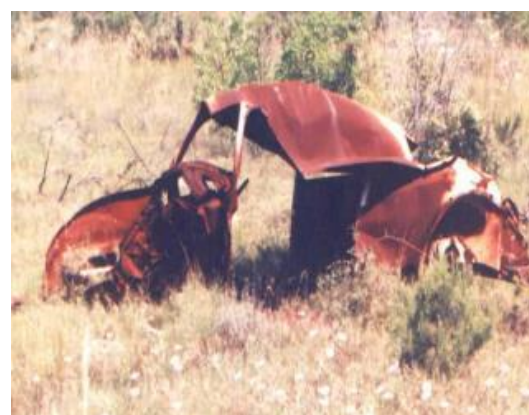
Slika 25. Primjer opće korozije [17]
