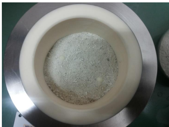
Slika 11 Uzorak školjaka nakon prvog usitnjavanja
