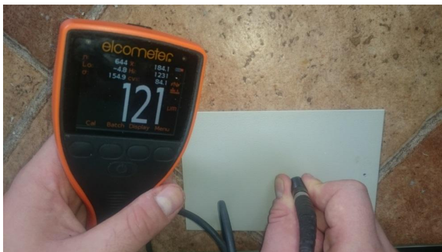
Slika 23. Postupak mjerenja debljine prevlake uređajem Elcometer 456
