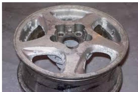
Slika 1. Korozija aluminijskih naplatka automobila [2]
