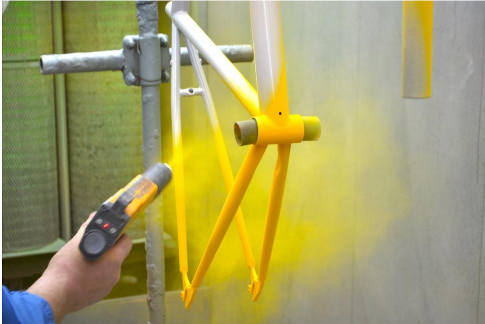
Slika 19. Praškasto prevlačenje bicikla [18]
