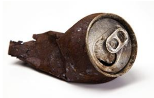
Slika 2. Korozija aluminijske limenke [3]
