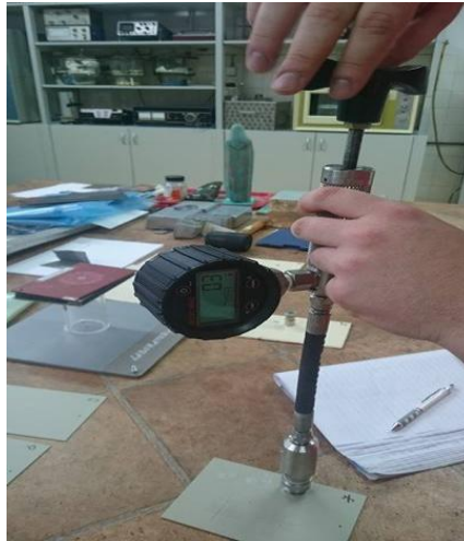
Slika 32. Ispitivanje Pull-off metodom
