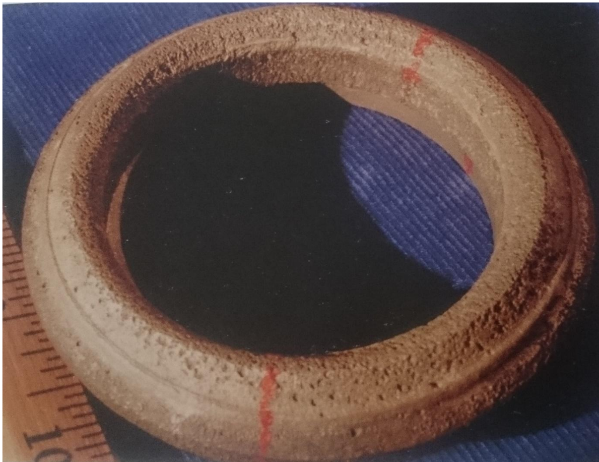
Slika 3. Rupičasta korozija aluminija [5]
