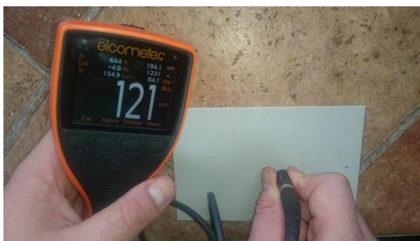
Slika 23. Postupak mjerjenja debljine prevlake uređajem Elcometer 456
