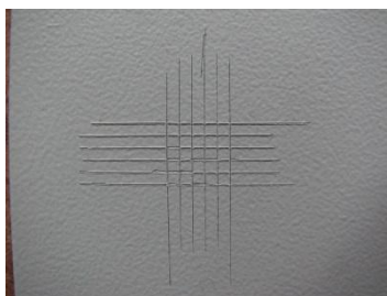
Slika 31. Početna prionjivost praškaste prevlake
