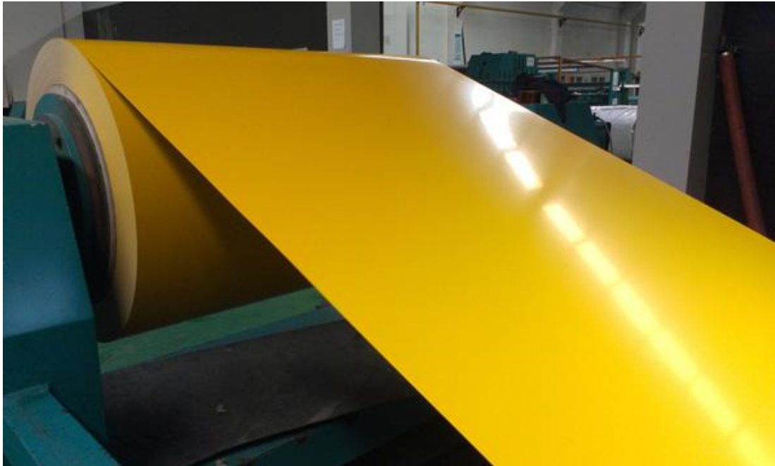
Slika 14. Poliesterska prevlaka aluminija [19]
