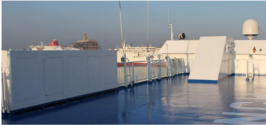
Slika 17. Paluba zaštićena poliuretanom [19]
