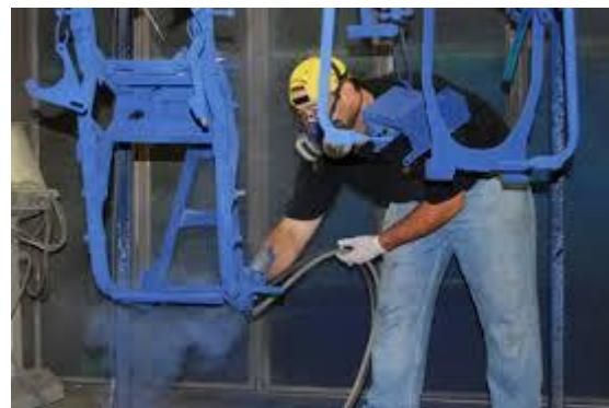
Slika 20. Elektrostatsko naprašivanje [18]
