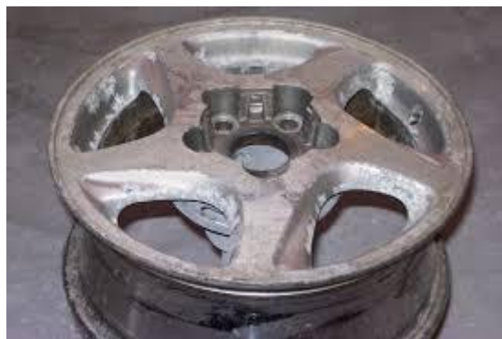
Slika 1. Korozija aluminijskih naplatka automobila [2]
