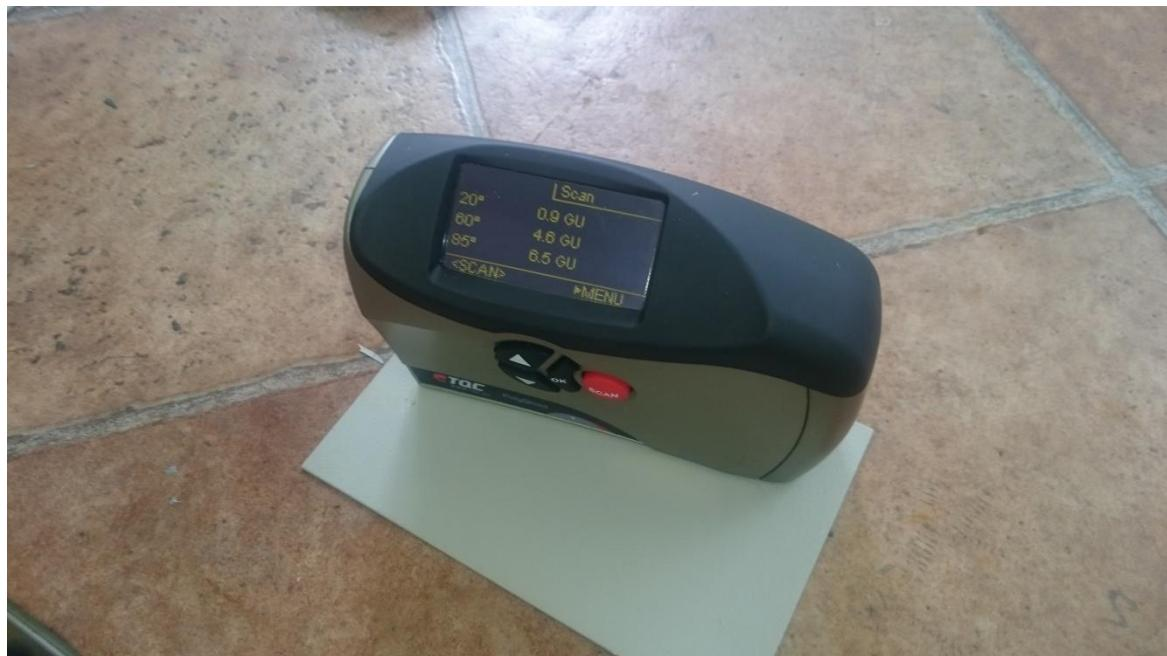
Slika 24. Ispitivanje sjaja uređajem TQC [16]
