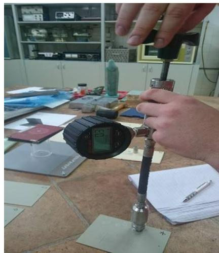
Slika 32. Ispitivanje Pull-off metodom
