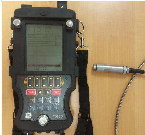
Slika 5. Digitalni ultrazvučni uređaj Krautkramer DMS-2
