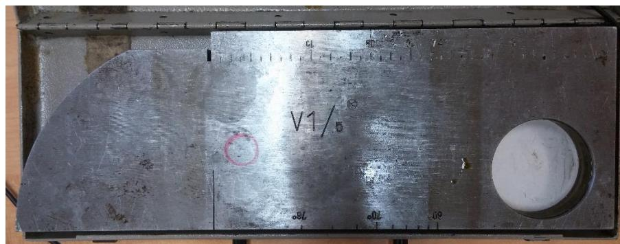
Slika 22. Mjerno mjesto na etalonu V1
