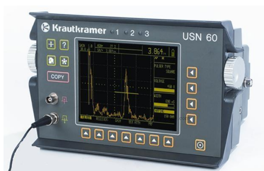
Slika 4. Digitalni ultrazvučni uređaj Krautkramer USN-60 [4]
