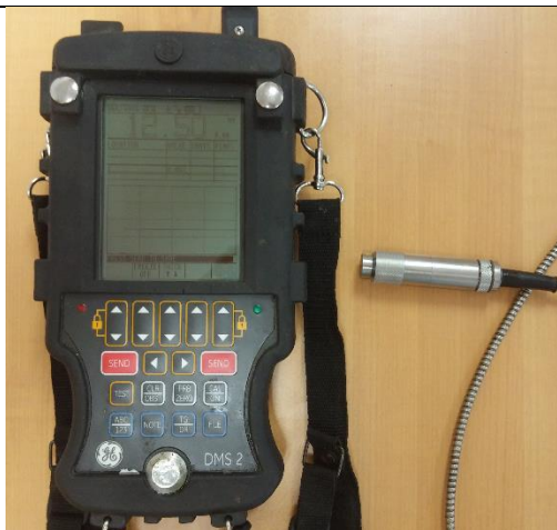
Slika 5. Digitalni ultrazvučni uređaj Krautkramer DMS-2
