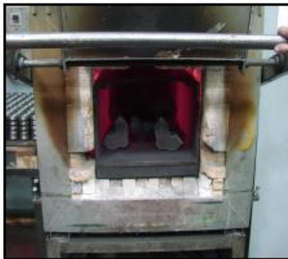
*Slika 4. Zagrijevanje kalupa u peći [6]*
