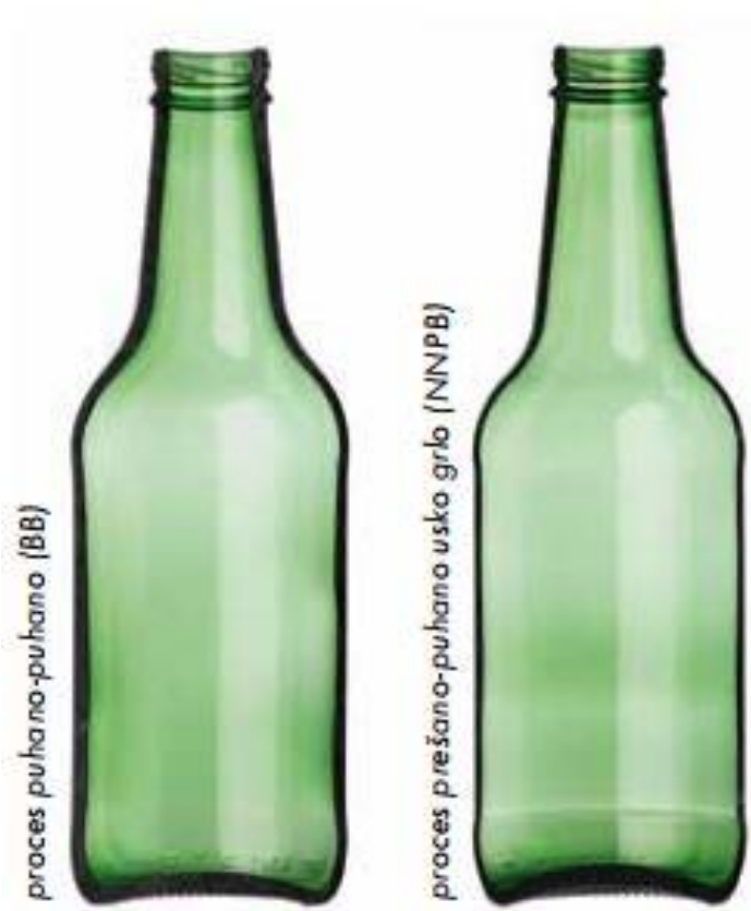
Slika 22. Usporedba boca dobivenih BB i NNPB postupkom [3]
