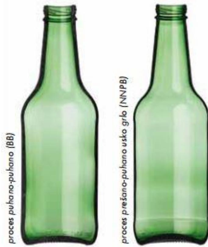
Slika 22. Usporedba boca dobivenih BB i NNPB postupkom [3]
