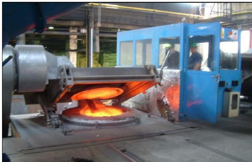
Slika 5.2 Srednje - frekventna indukcijska peć
