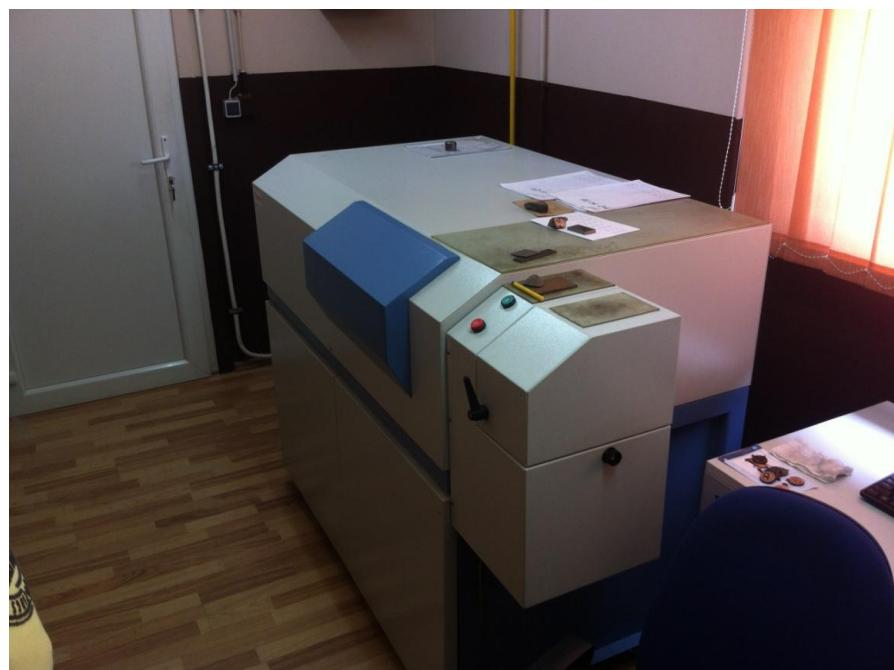
Slika 5.10 ARL 3460- uređaj za ispitivanje kemijskog sastava
