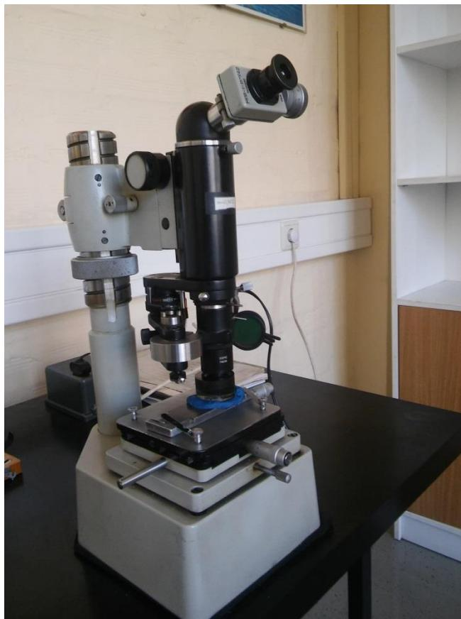
Slika 5.17 Uredaj za ispitivanje mikrotvrdoće
