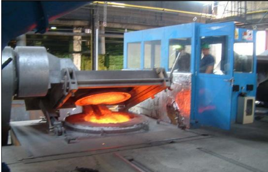
Slika 5.2 Srednje - frekventna indukcijska peć
