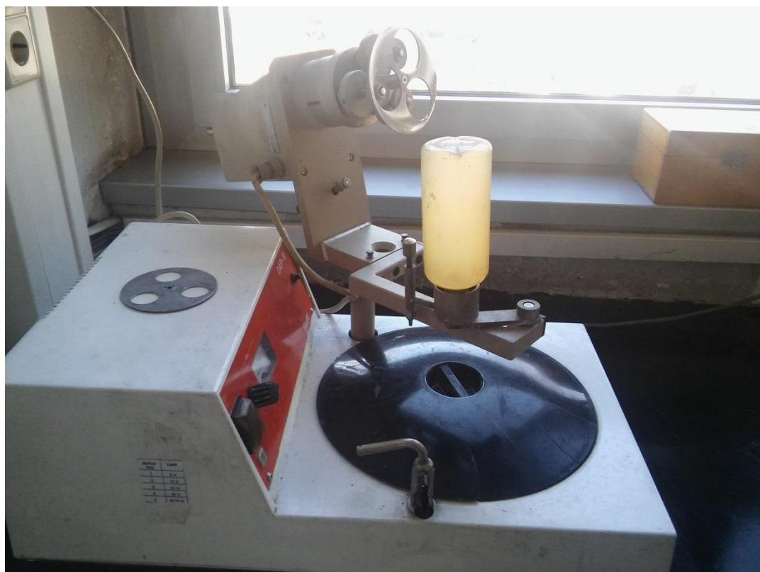
Slika 5.15 Uređaj za poliranje uzorka
