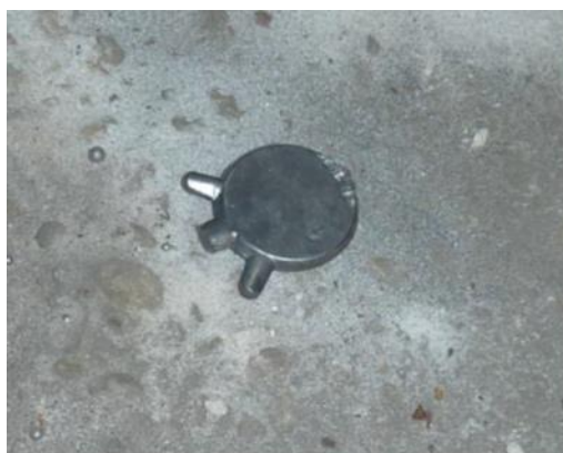
Slika 5.10 Uzorak za određivanje kemijskog sastava
