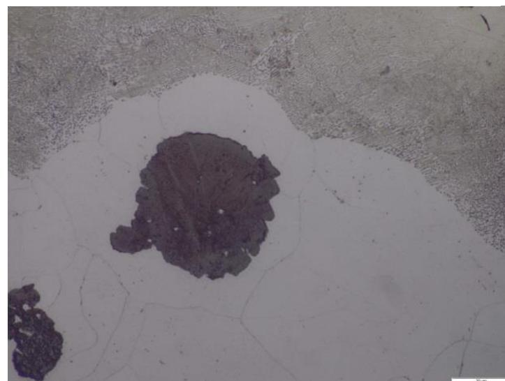
Slika 6.3 Mikrostruktura uzorka od nodularnog lijeva,
