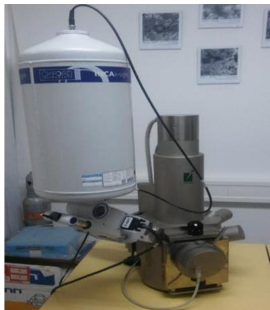
Slika 5.12 Skenirajući elektronski mikroskop „Tescan Vega 5136 FM“
