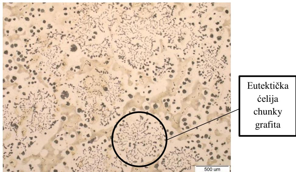
Slika 6.1 Mikrostruktura uzorka od nodularnog lijeva,
