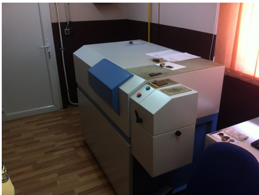
Slika 5.10 ARL 3460- uređaj za ispitivanje kemijskog sastava
