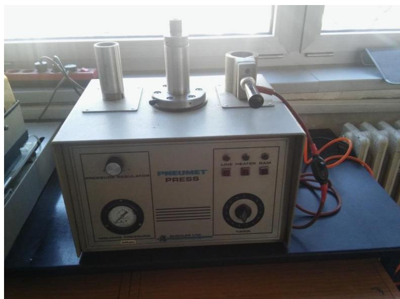
Slika 5.16 Uređaj za izradu kalupa
