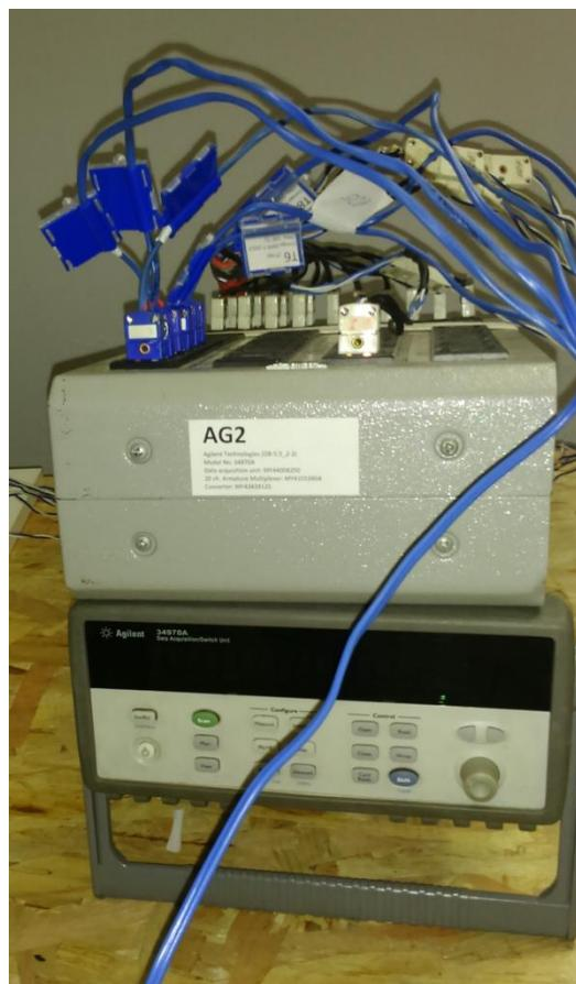
Slika 10. Analogno-digitalni pretvarač
