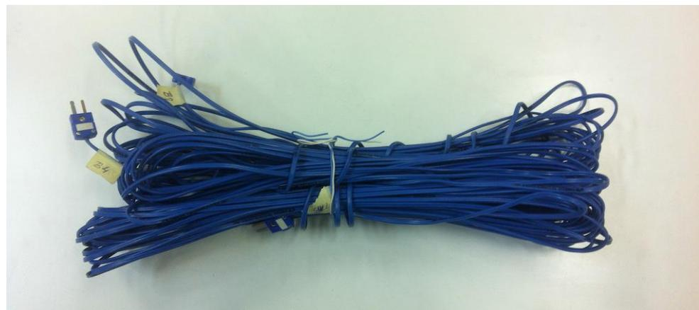
**Slika 8. Termoparovi tipa T**
