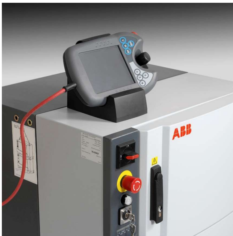
Slika 14. Prikaz upravljačkog privjeska ABB FlexPendant sa držačem [16]
