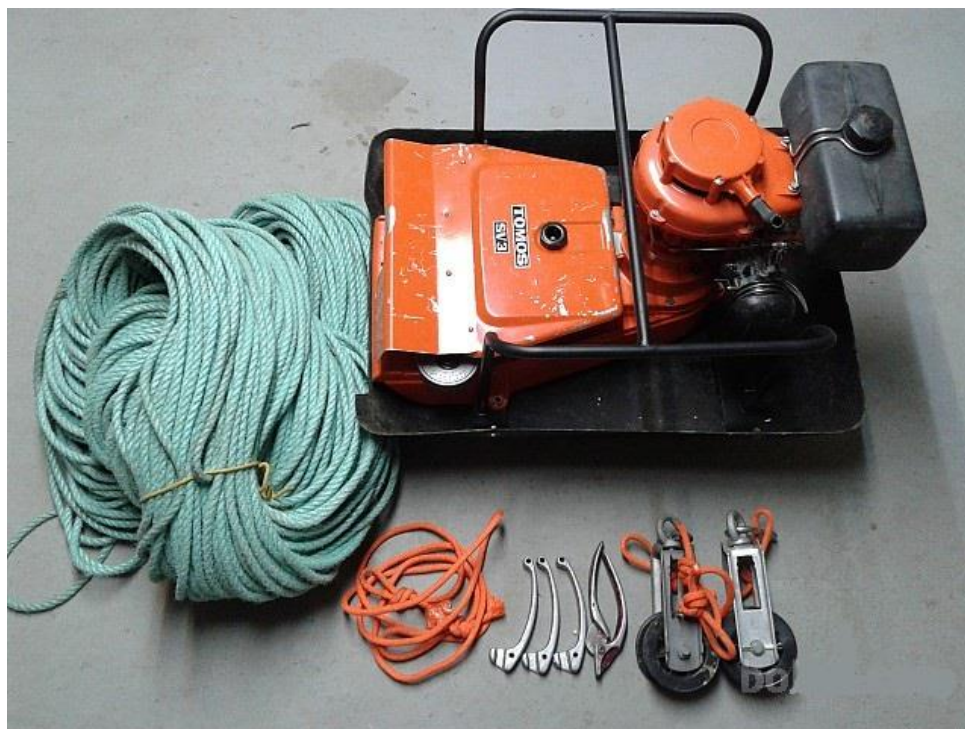
Slika 3. Tomos SV 3.5 skijaška vučnica
