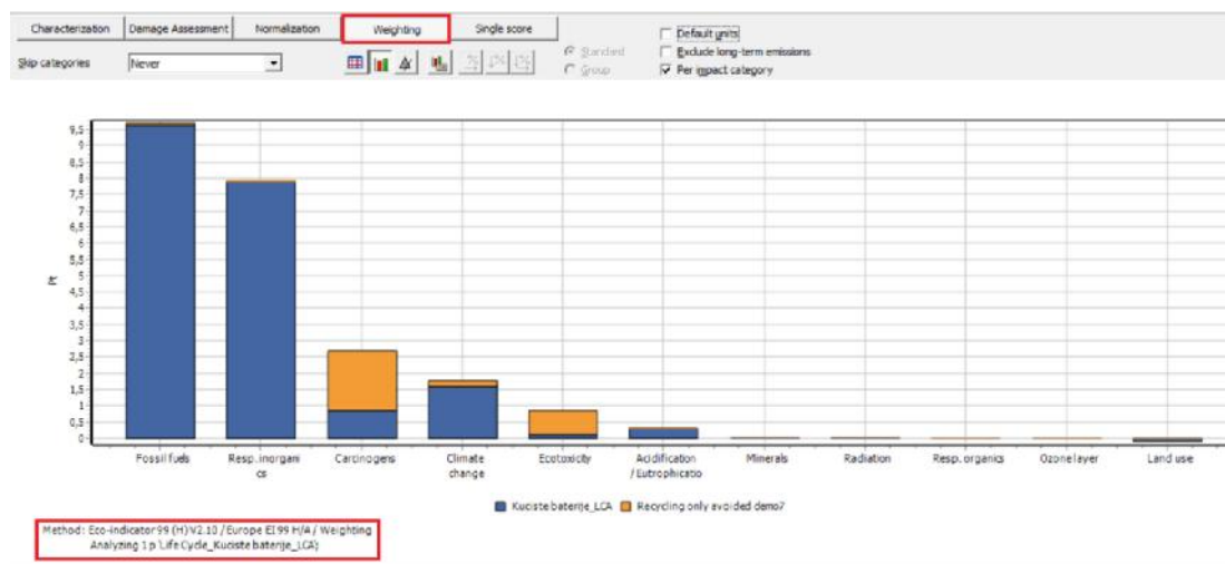
Slika 27. Prikaz faze „weighting“ na cjelokupni proces
