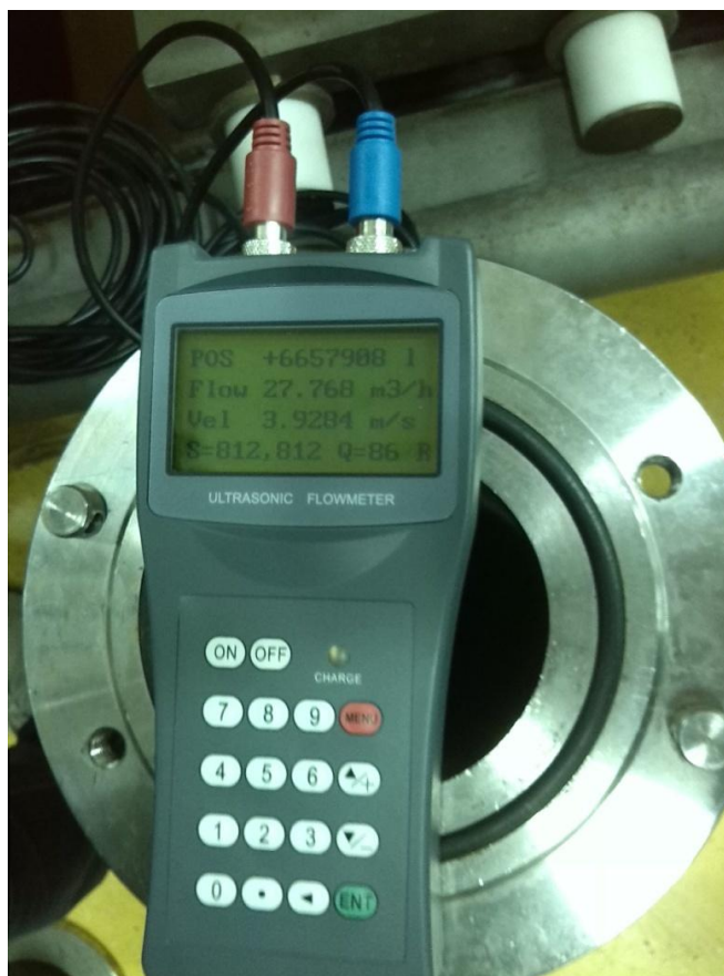
Slika 12. Ispitivano ultrazvučno mjerilo protoka priključeno na mjernoj liniji u laboratoriju
