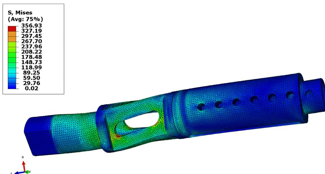
Slika 12. Raspodjela naprezanja na vratilu V2
