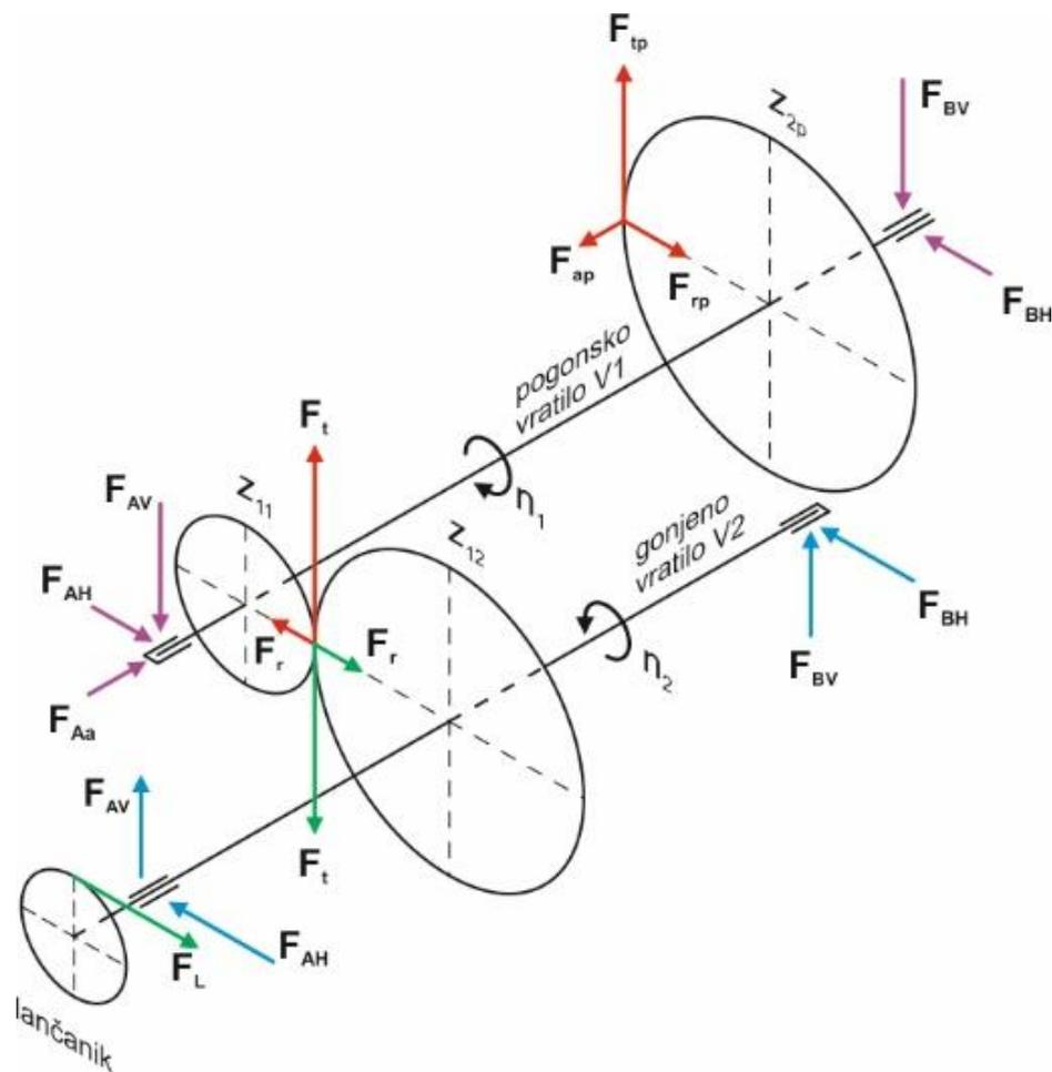
Slika 8. Shematski prikaz vratila i opterećenja
